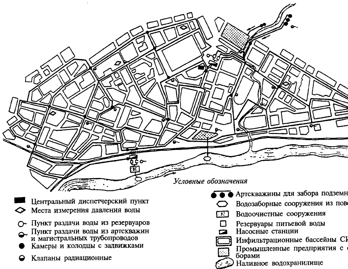
Рис. 1. Принципиальная схема устройства системы хозяйственно-питьевого водоснабжения
