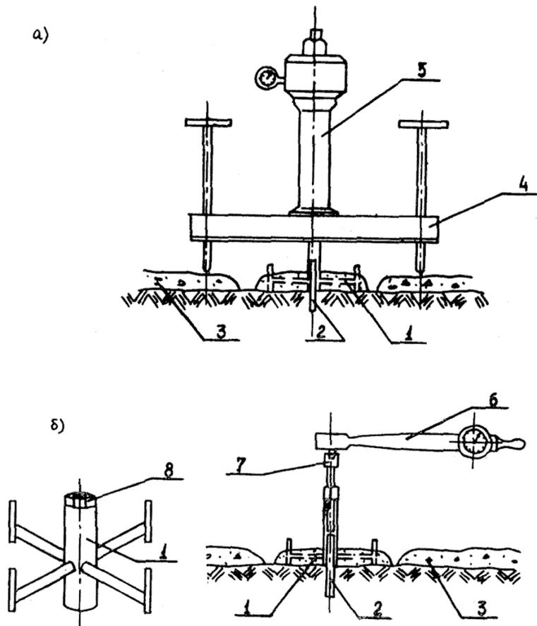
Определение сцепления набрызгбетонного покрытия с поверхностью выработки
