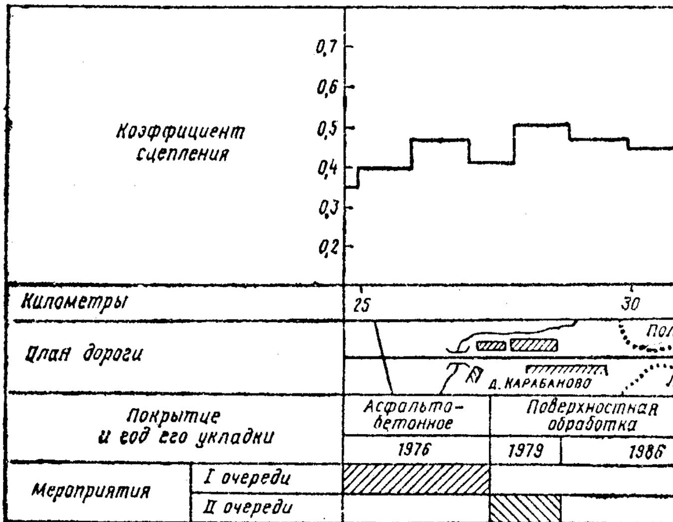
Рис. 2.7. Линейный график коэффициентов сцепления
