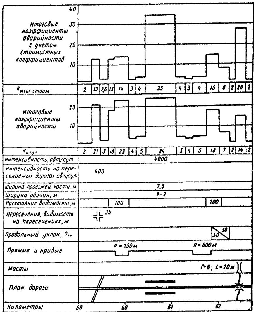
Рис. 1.3. Уточнение графика итоговых коэффициентов аварийности введением поправочных коэффициентов тяжести ДТП
