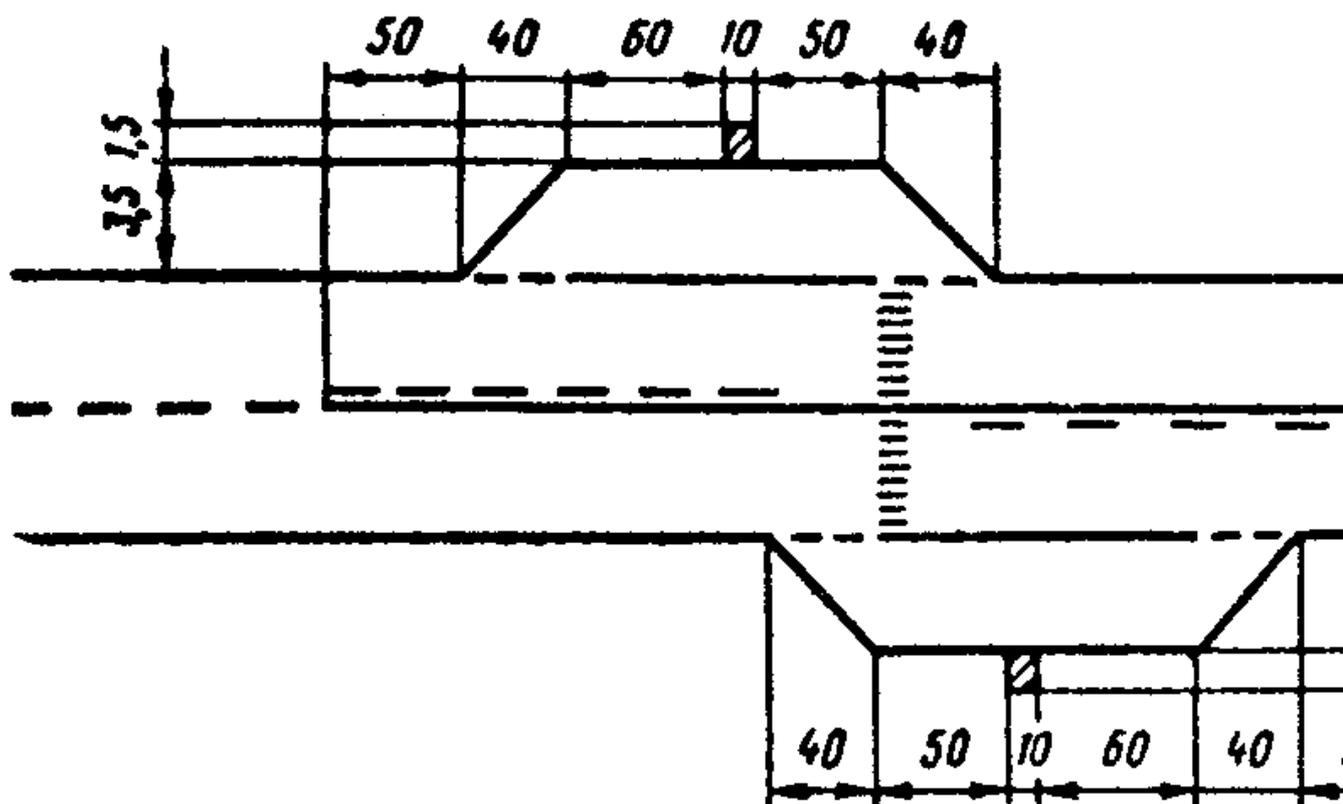
**Рис. 10.2. Оборудование автобусных остановок в насе**
