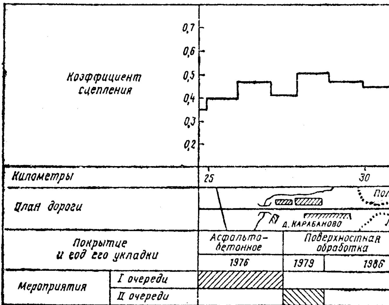
Рис. 2.7. Линейный график коэффициентов сцепления
