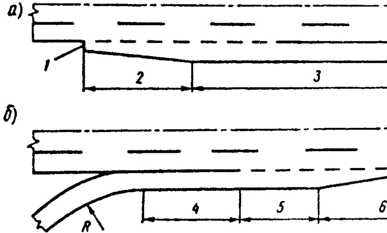
**Рис. 7.7. Элементы полос торможения (а) и разгона (б)**
