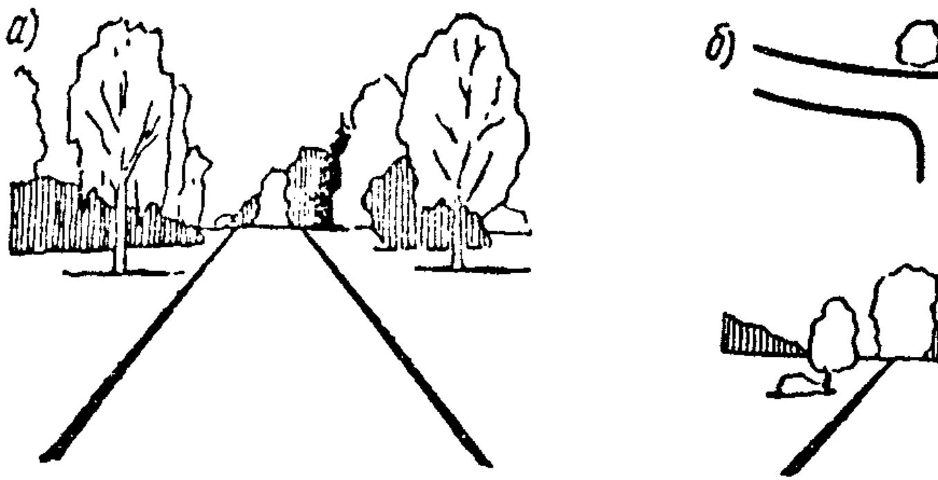
**Рис. 3.6. Использование деревьев для подчеркивания направления дороги**
