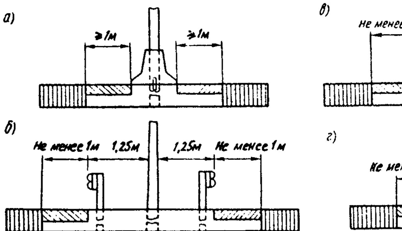
**Рис. 15.2. Схема установки опор освещения и ограждений на разделительной полосе (а, б) и обочине (в, г)**
