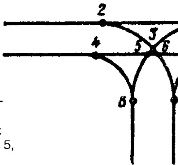
**Рис. 1.4. Схема конфликтных точек на примыканиях автомобильных дорог в одном уровне:**
