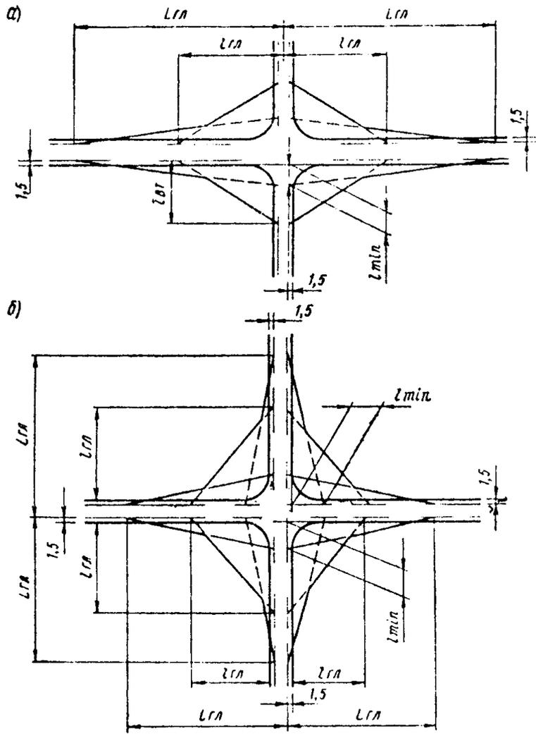
Рис. 6.1. Схемы определения видимости на пересечениях в одном уровне:
