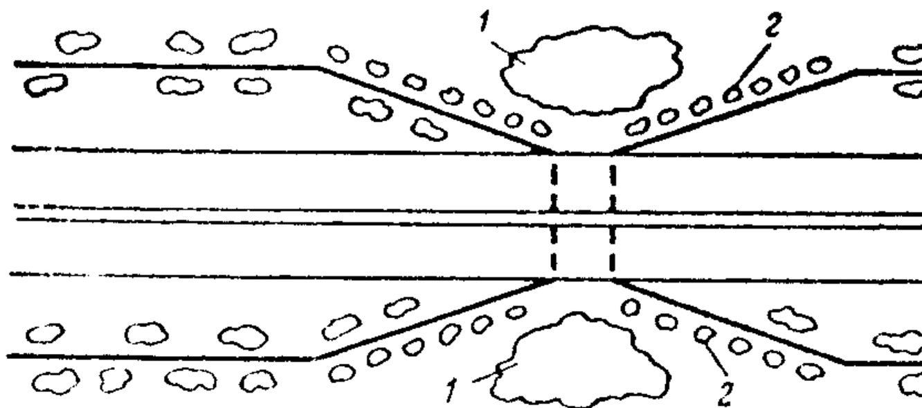
**Рис. 16.11. Схема устройства перехода для диких животных**
