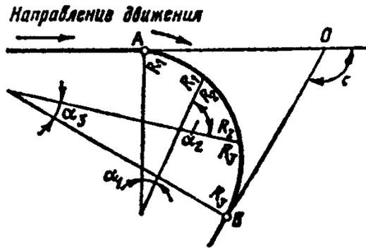
Рис. 6.4. Схема для расчета коробовой кривой
