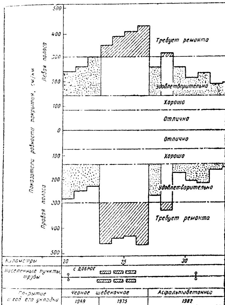
Рис. 2.6. Линейный график ровности
