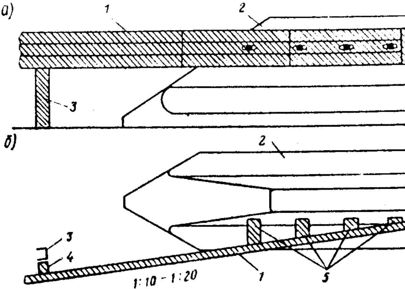
**Рис. 11.2. Сопряжение барьерного ограждения с парапетным**
