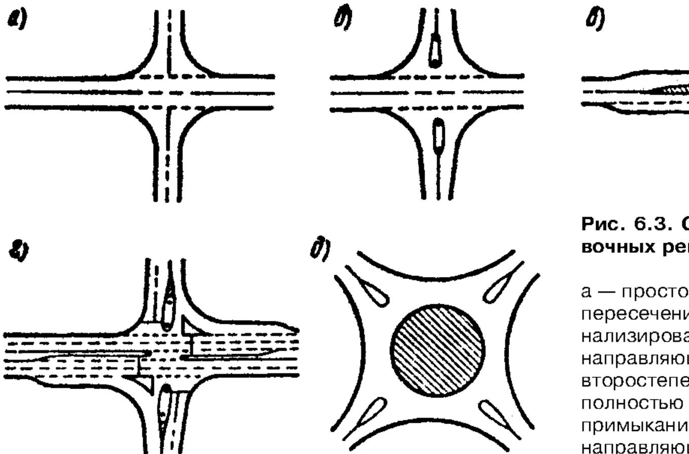
Рис. 6.3. Схемы планировочных решений пересечений
