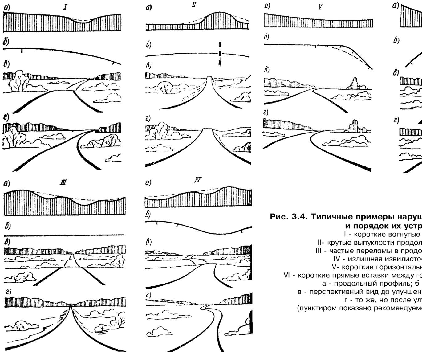
**Рис. 3.4. Типичные примеры нарушения плавности трассы и порядок их устранения**
