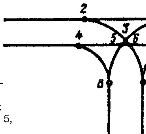
**Рис. 1.4. Схема конфликтных точек на примыканиях автомобильных дорог в одном уровне:**
