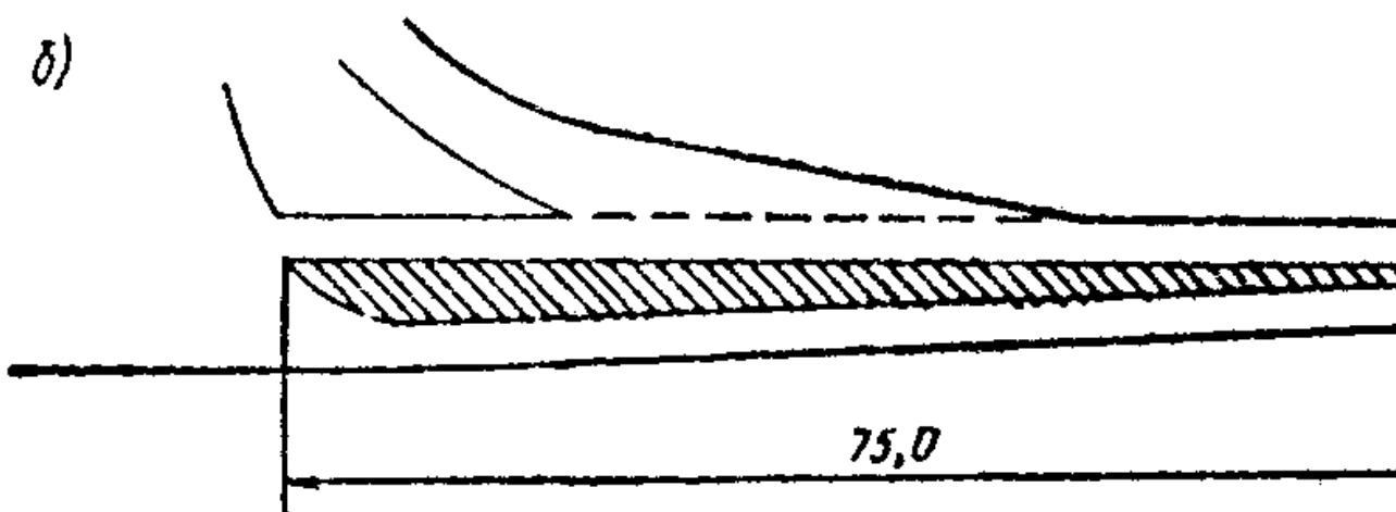
**Рис. 6. 13. Расположение островков на главной дороге**
