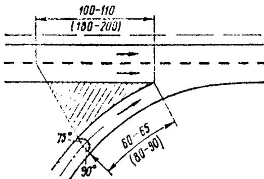
**Рис 7.5. Параметры треугольника видимости на выходных участках съездов транспортных развязок**
