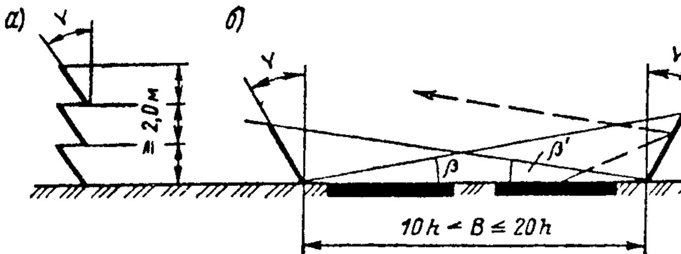
Рис. 16.6. Схема ступенчатого шумоотражающего барьера с метрическими размерами:
