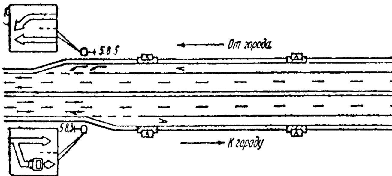
**Рис. 13.3. Схема движения при устройстве дополнительной полосы для автобусов**
