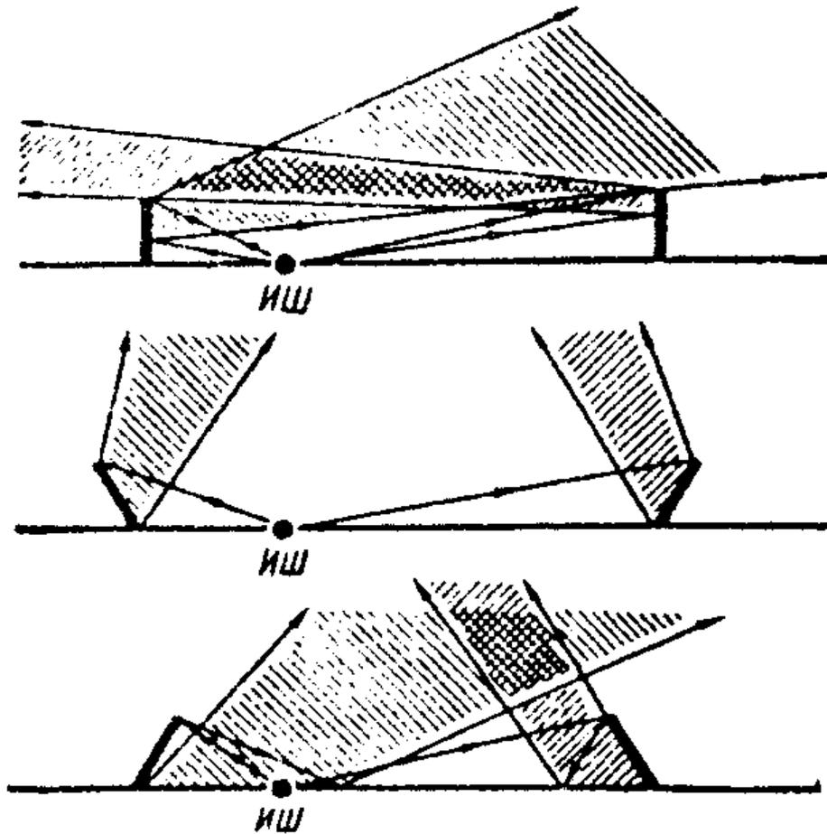
**Рис. 16.5. Отражение звука от барьеров при различном их наклоне:
