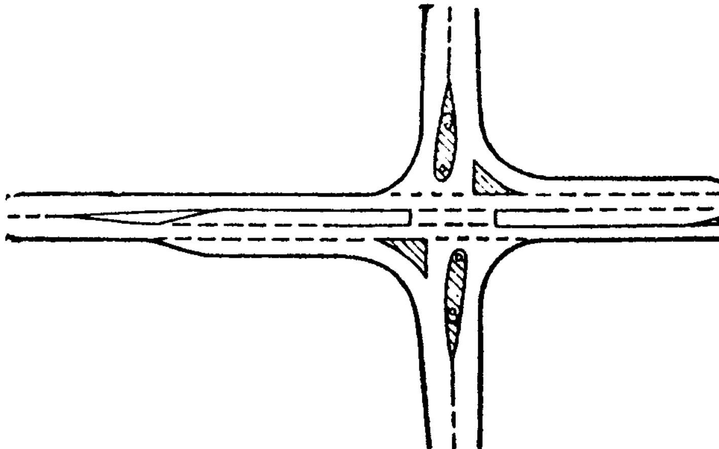
**Рис. 6.15. Выделение островков на проезжей части разметкой**
