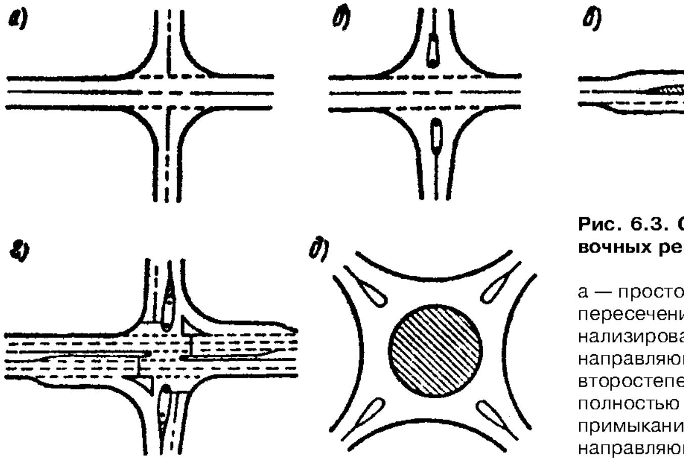
Рис. 6.3. Схемы планировочных решений пересечений
