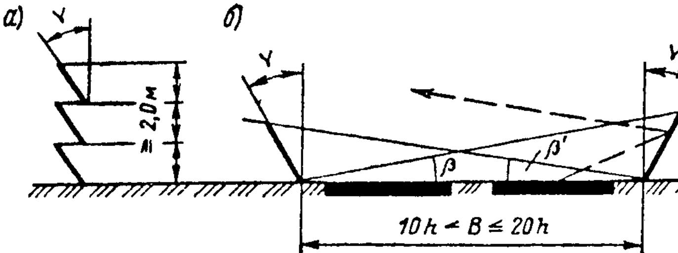
Рис. 16.6. Схема ступенчатого шумоотражающего барьера с основными геометрическими размерами:
