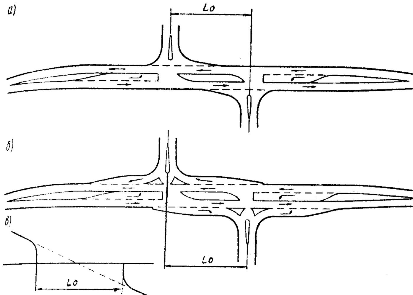
**Рис. 6.7. Перестройка пересечения на два смещенных примыкания:**
