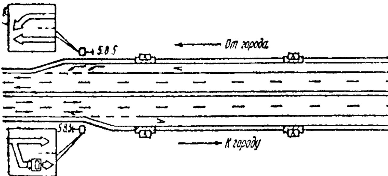
**Рис. 13.3. Схема движения при устройстве дополнительной полосы только для автобусов**
