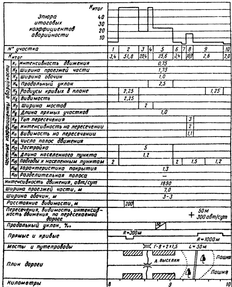
Рис. 1.2. Пример графика итоговых коэффициентов аварийности
