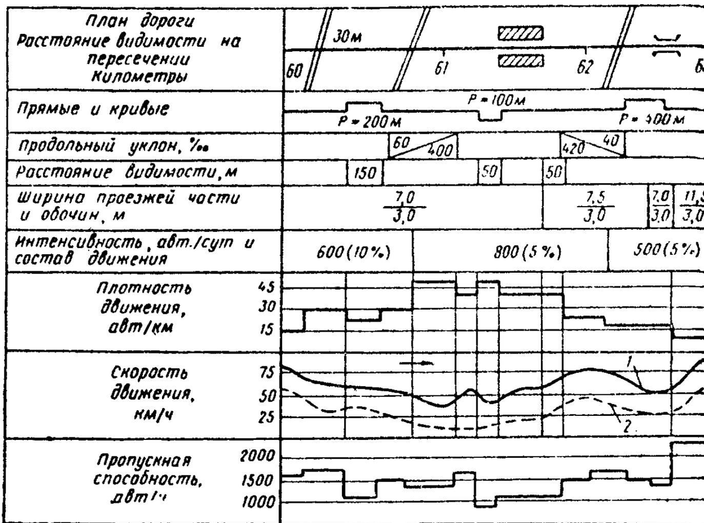
Рис. 2.2. График изменения режима движения по длине дороги:
