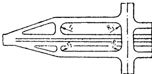
**Рис. 7.6.Схема планировки развязки обжатый «клеверный лист»**
