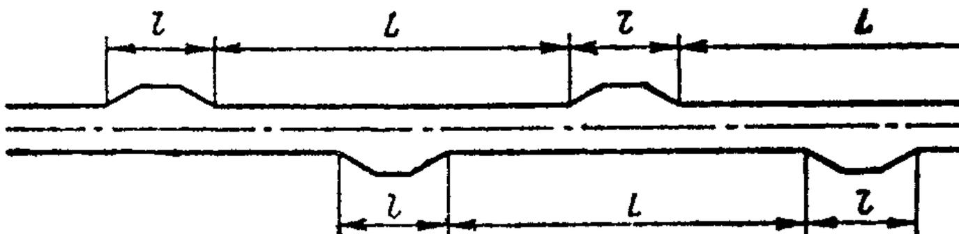
**Рис. 13.6. Расположение дополнительных обгонных полос I на участке дороги с интенсивным движением тракторов**
