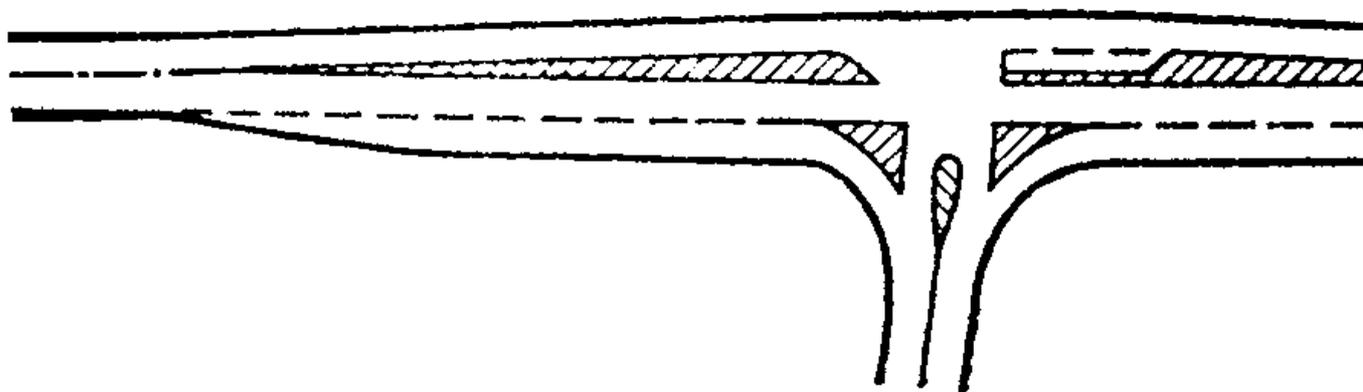
**Рис. 6.10. Направляющие островки на примыкании в одном уровне**
