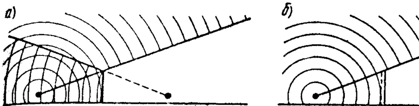
**Рис. 16.4. Схема распространения шума при устройстве б**
