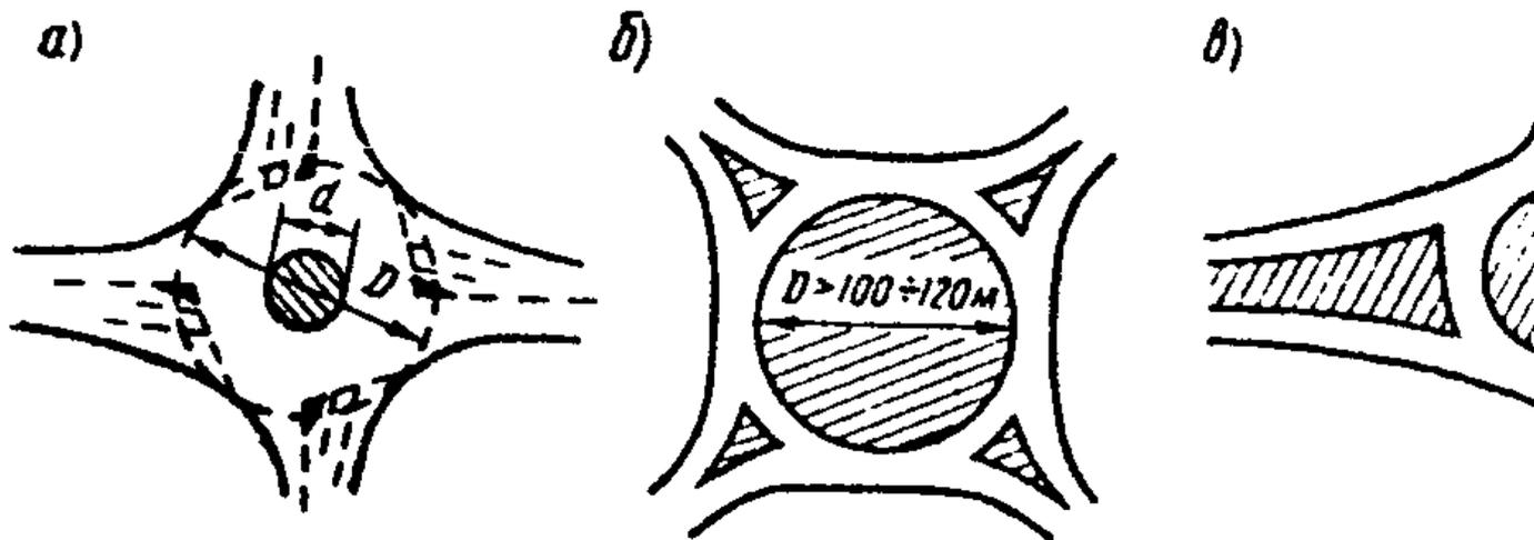
Рис. 6.16. Планировочные схемы кольцевых пересечений
