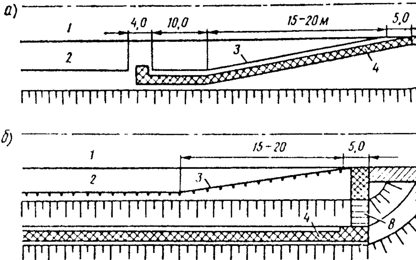
**Рис. 11.1. Схема расположения ограждений и пешеходных дорожек на подходах к мостам:**
