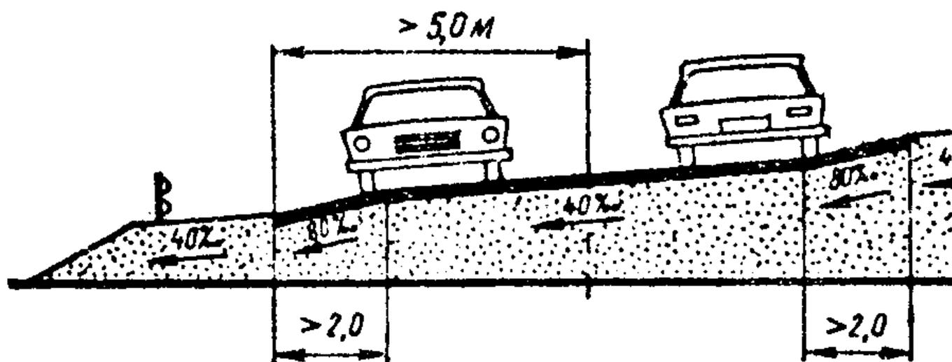
**Рис. 4.1. Схема устройства ступенчатого виража на кривых**
