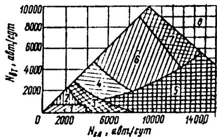
Рис. 6.2. Номограмма для выбора типа планировочных решений пересечений:
