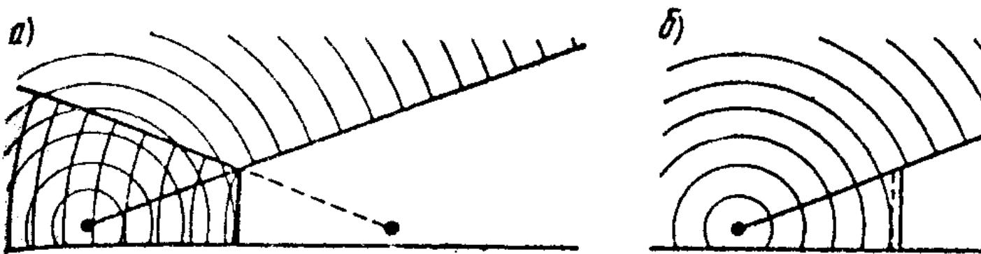
**Рис. 16.4. Схема распространения шума при устройстве барьера**
