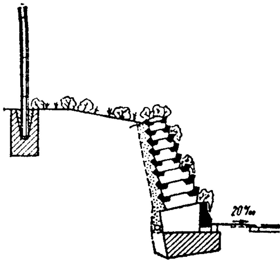
**Рис. 16.1. Пример образования сложной для службы эксплуатации зоны между двумя шумозащитными сооружениями**
