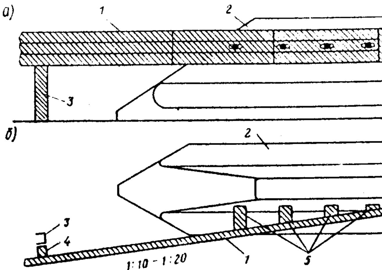
**Рис. 11.2. Сопряжение барьерного ограждения с парапетным**
