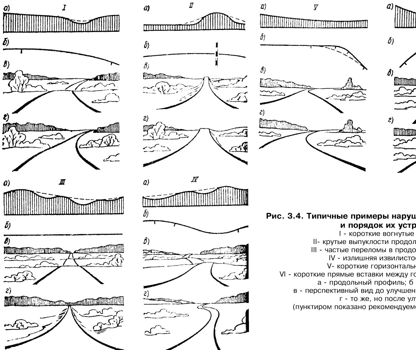
**Рис. 3.4. Типичные примеры нарушения плавности трассы и порядок их устрани**
