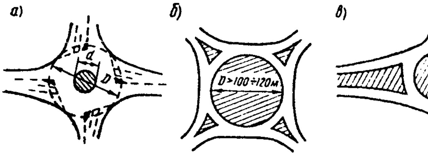
**Рис. 6.16. Планировочные схемы кольцевых пересечений**
