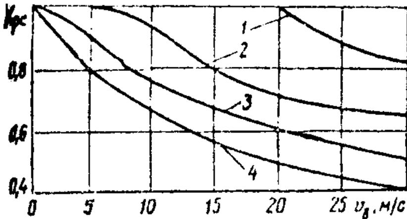
**Рис. 1.8. Зависимости коэффициента обеспеченности расчетных скоростей от скорости ветра**
