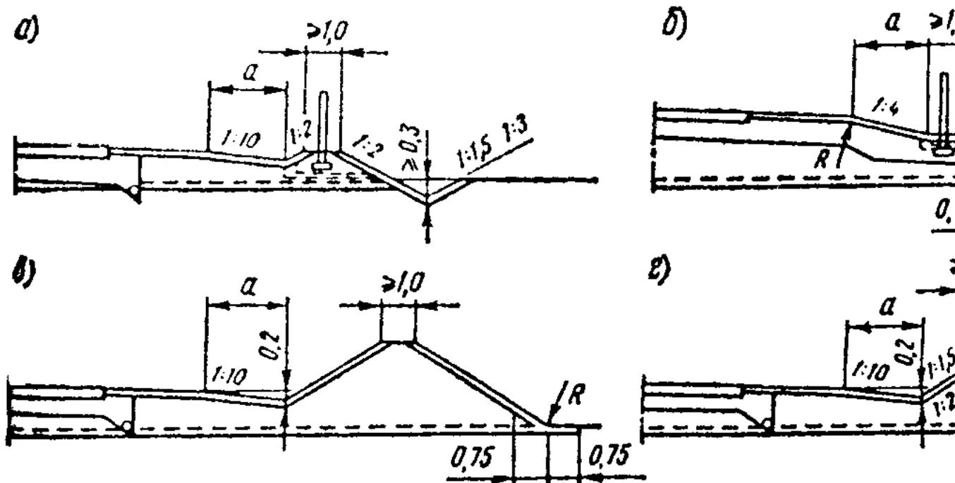
**Рис. 16.8. Рекомендуемые поперечные профили земляного полотна размещения шумозащитных сооружений:**
