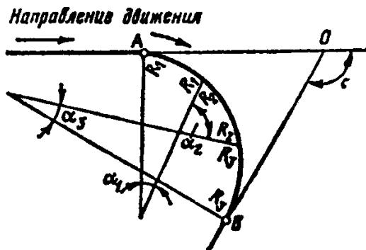
Рис. 6.4. Схема для расчета коробовой кривой
