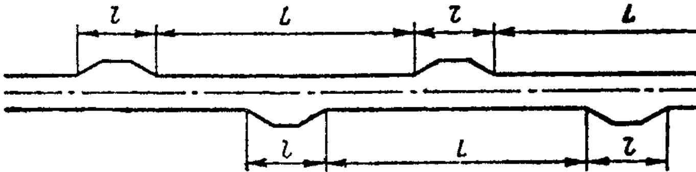
**Рис. 13.6. Расположение дополнительных обгонных полос I в плане на участке дороги с интенсивным движением тракторов**
