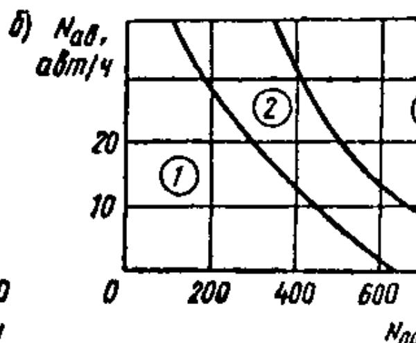
Рис. 13.2. Области применимости различных планировочных решений в зоне автобусных остановок
