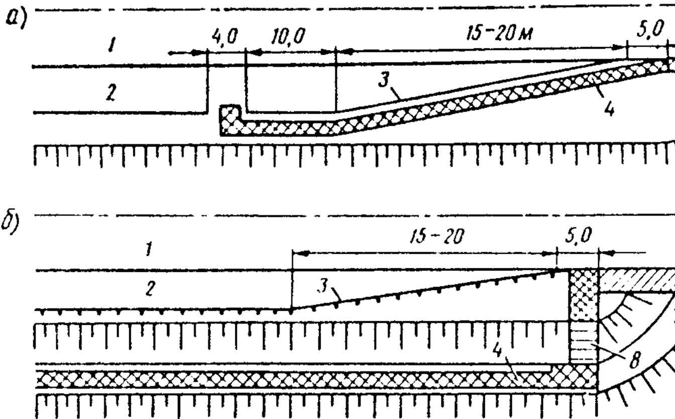
**Рис. 11.1. Схема расположения ограждений и пешеходных дорожек к мостам:**
