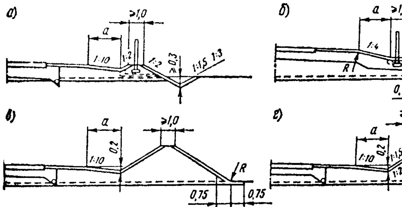
**Рис. 16.8. Рекомендуемые поперечные профили земляного полотна для размещения шумозащитных сооружений:**
