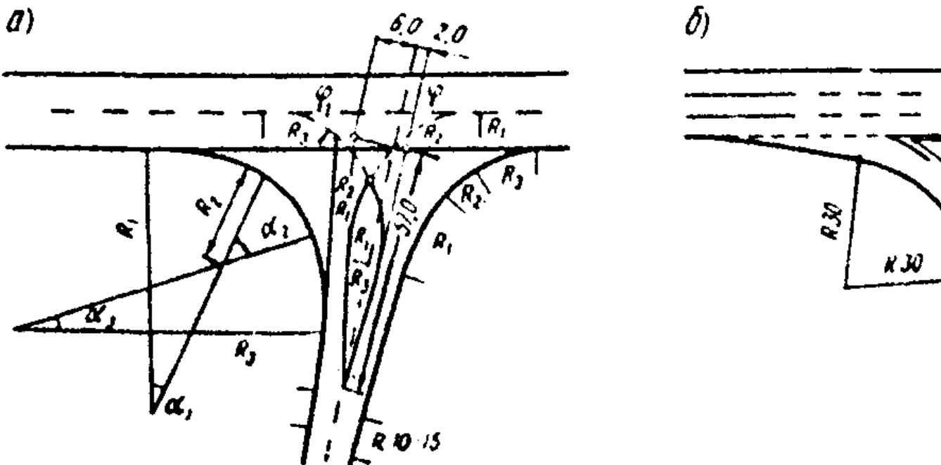
**Рис. 6.12. Расположение островков на второстепеной дороге**
