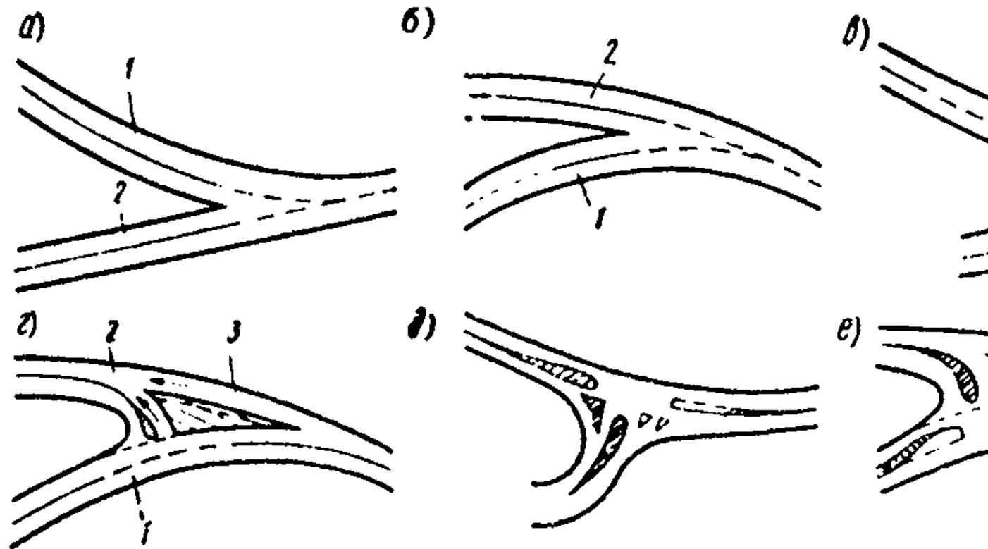
**Рис. 6.6. Рекомендуемые схемы планировки пересечений в одном уровне на обходе городов:**
