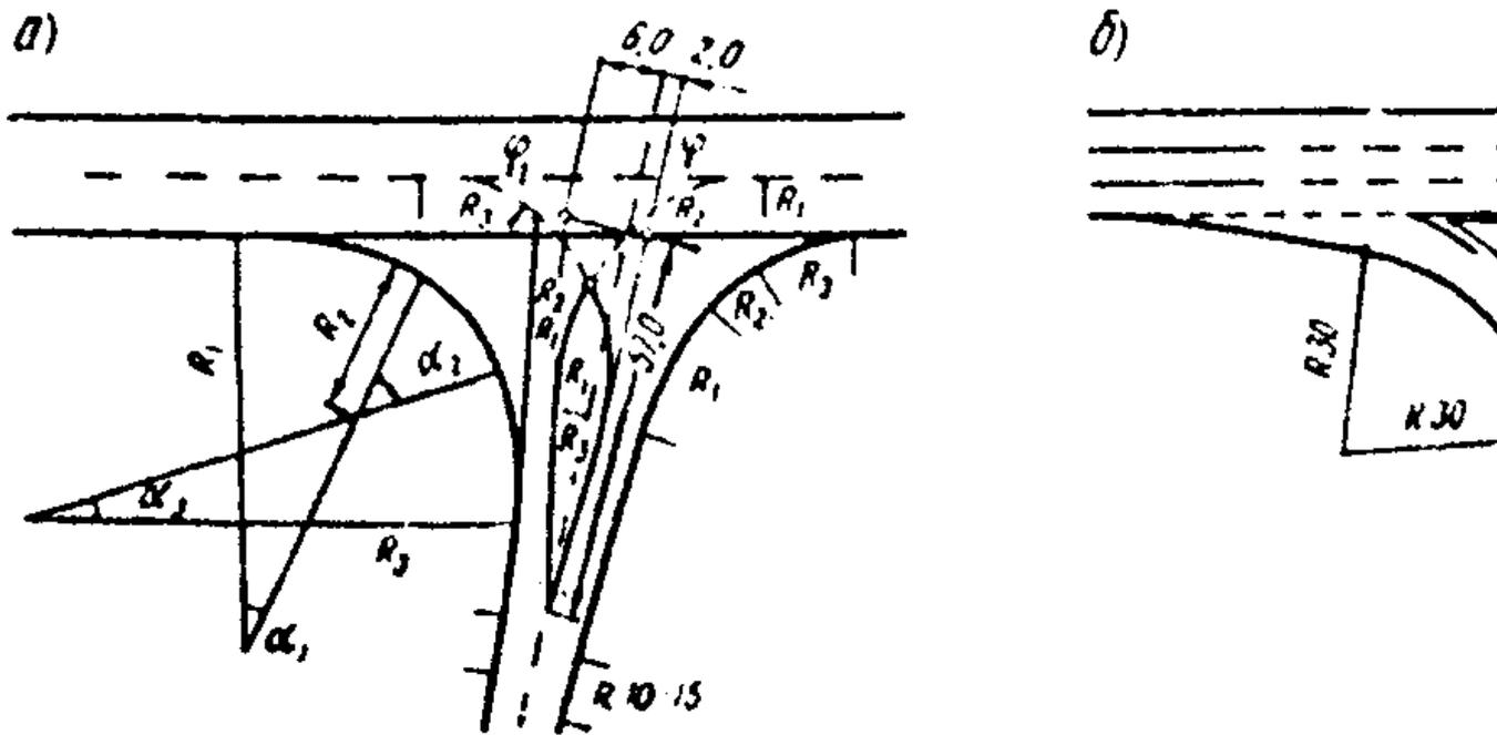
**Рис. 6.12. Расположение островков на второстепенной дороге**
