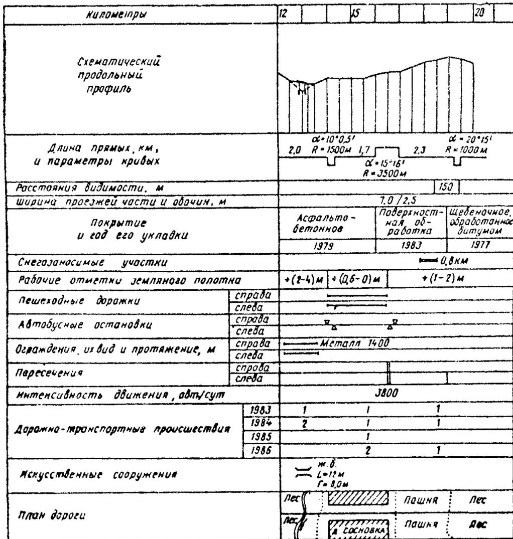
Рис. 2.1. Линейный график дороги
