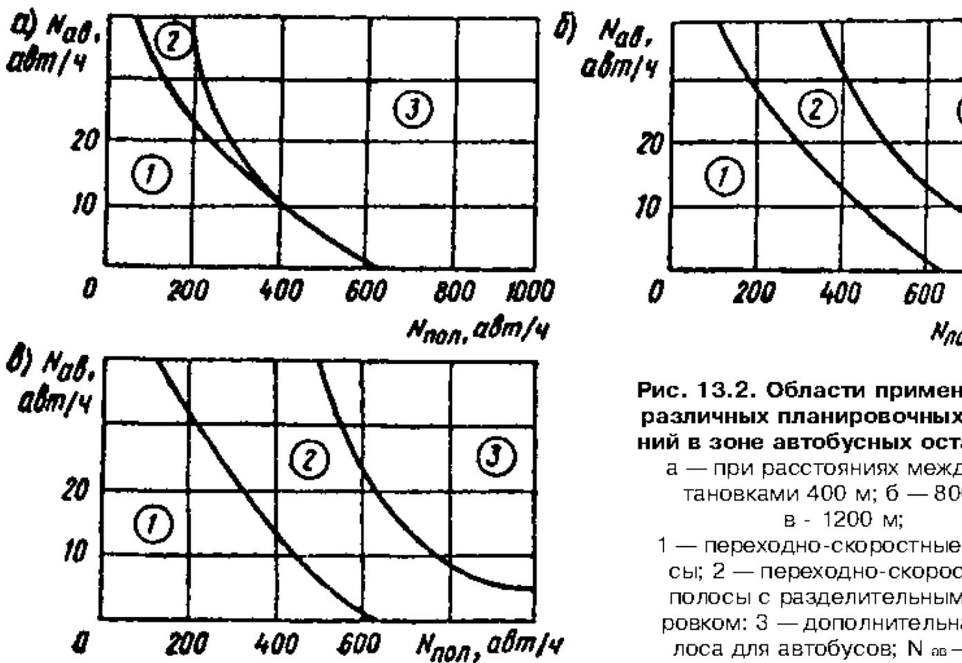
Рис. 13.2. Области применения различных планировочных решений в зоне автобусных остановок:
