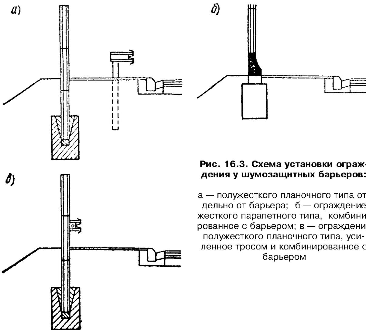
**Рис. 16.3. Схема установки ограждения у шумозащитных барьеров:**
