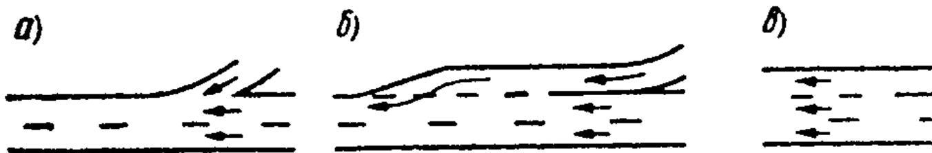
**Рис. 7.2. Варианты планировки выходных участков съездов, примыкающих к основной проезжей части**
