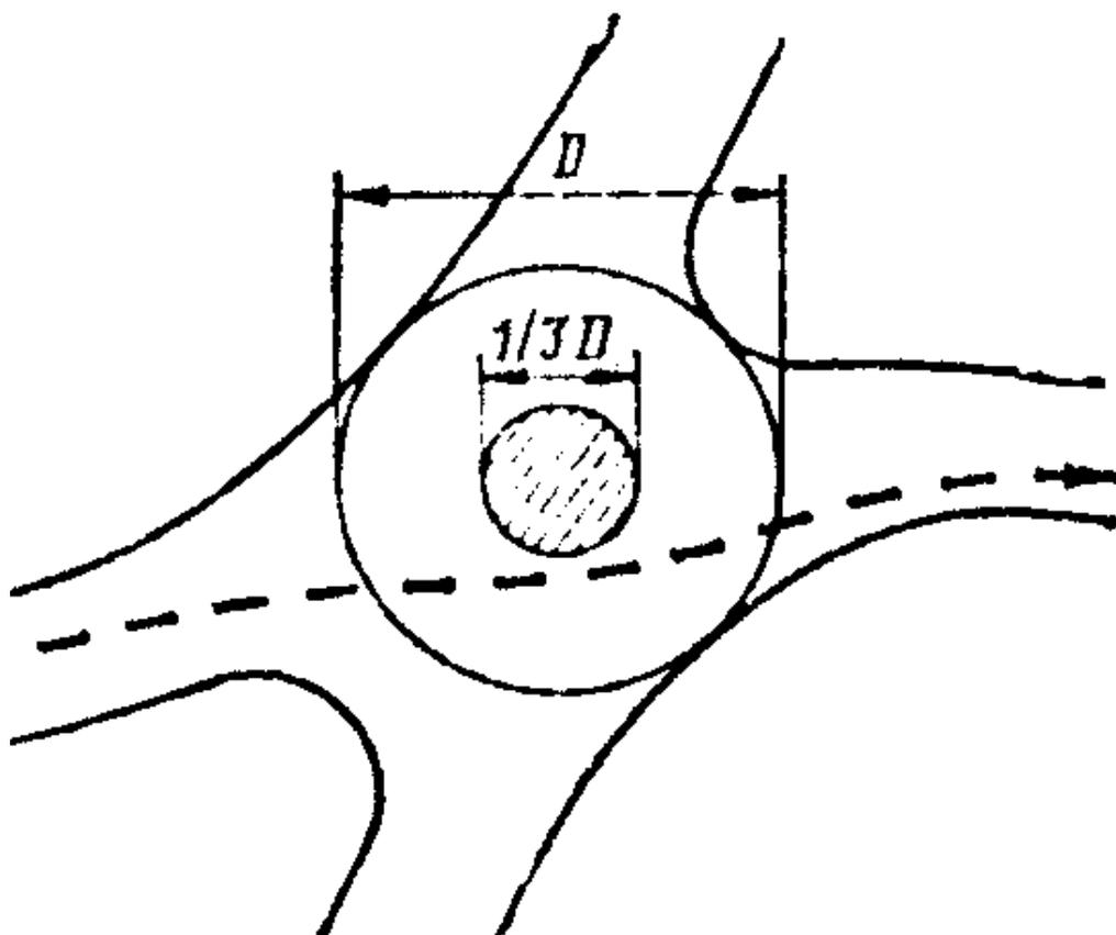
**Рис. 6.17. Улучшение условий движения на пересечении путем устройства островков небольшого диаметра**
