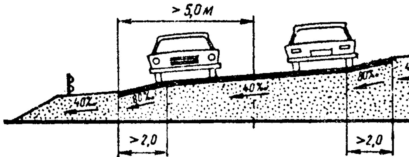
**Рис. 4.1. Схема устройства ступенчатого вираже на кривых**
