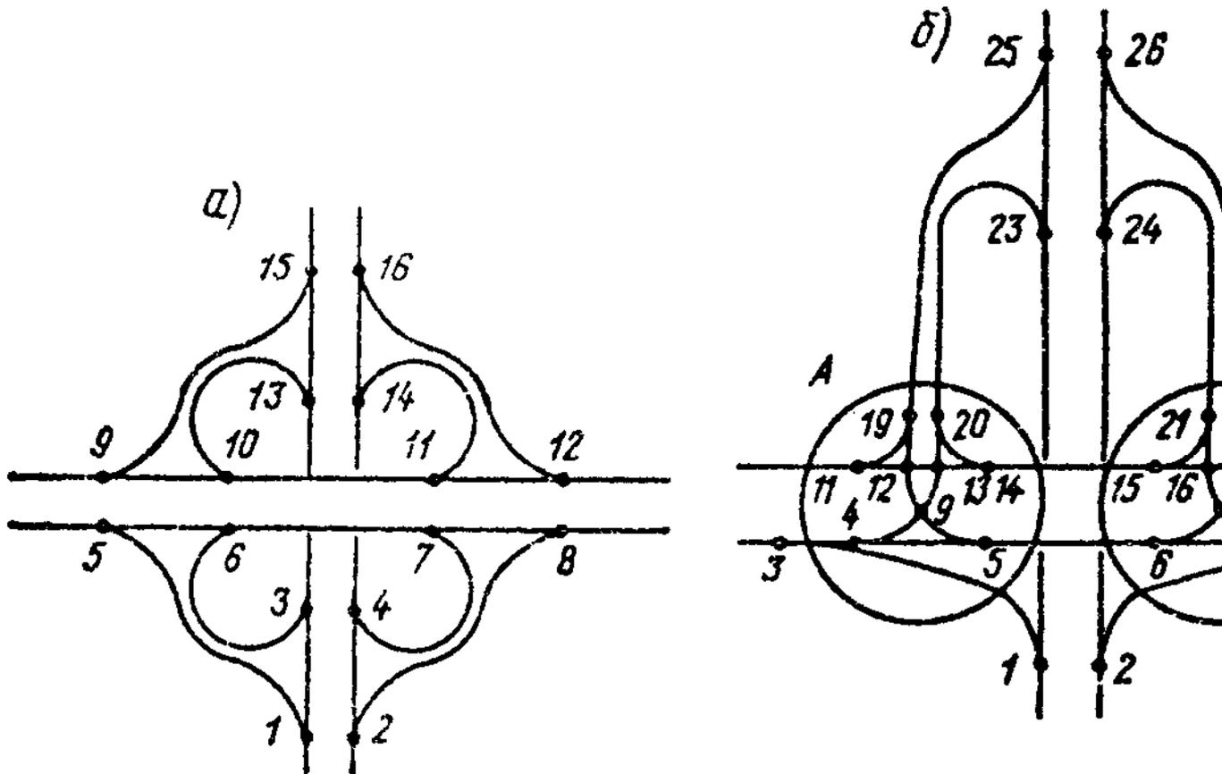
Рис. 1.5. Схема конфликтных точек на транспортных развязках
