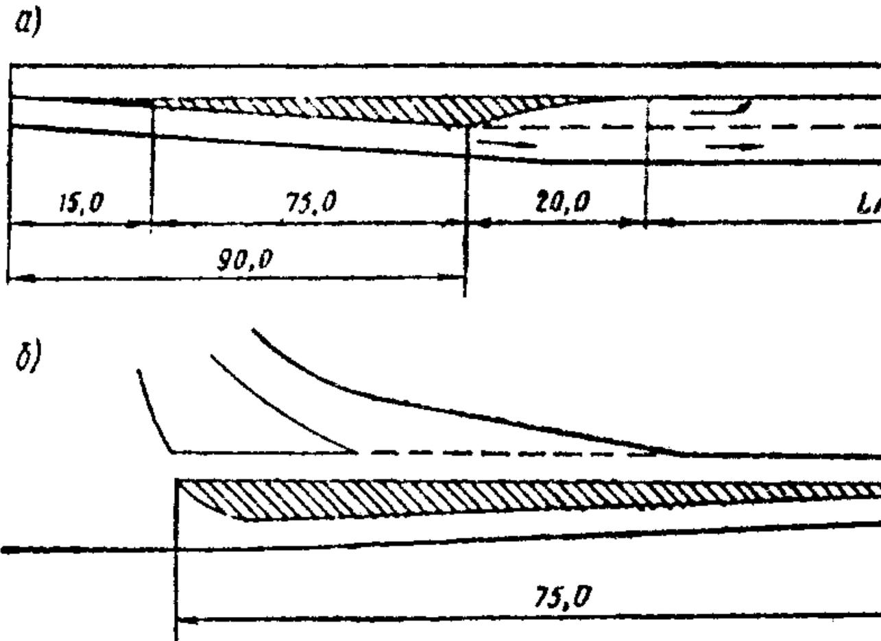
**Рис. 6. 13. Расположение островков на главной дороге**
