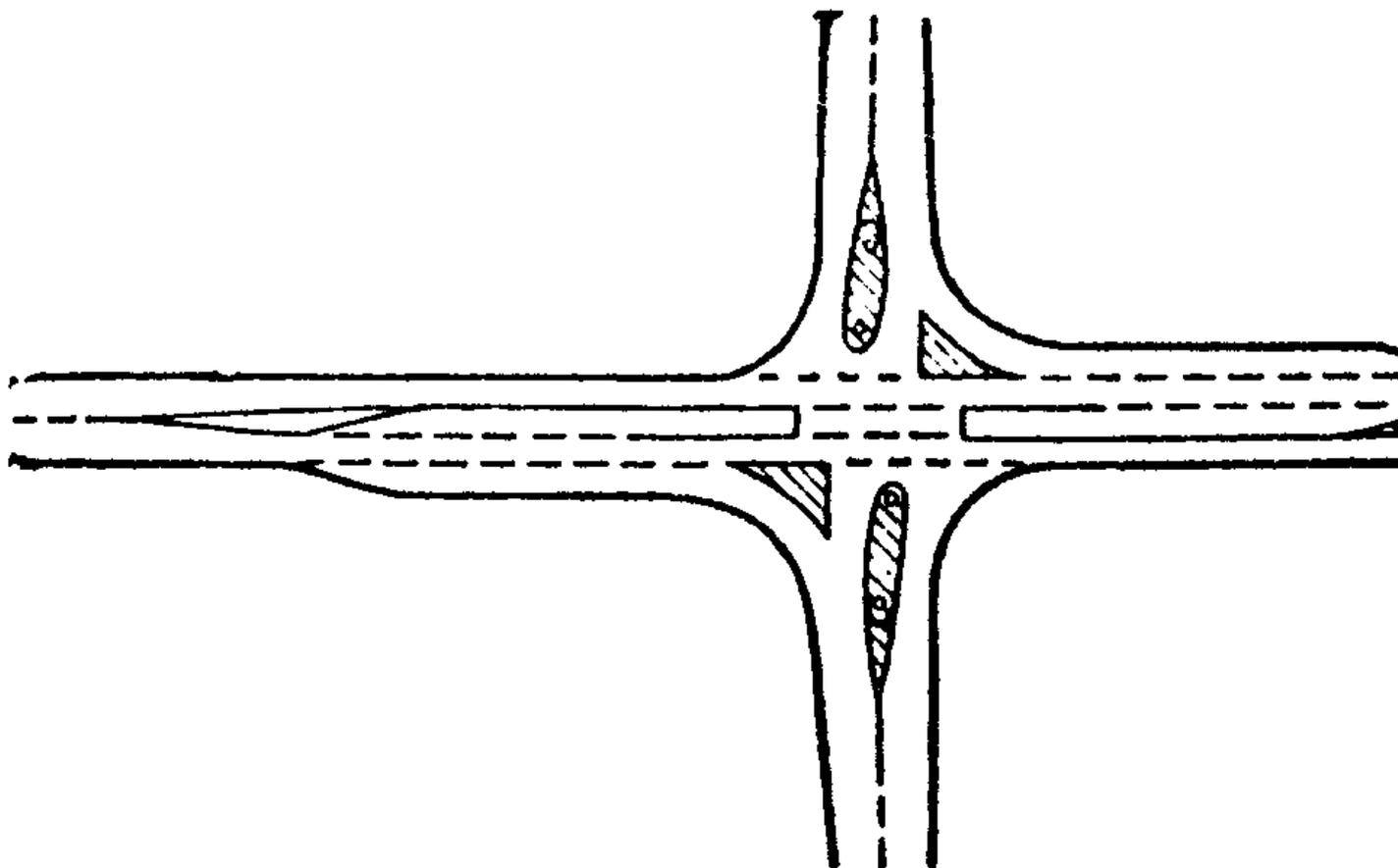
**Рис. 6.15. Выделение островков на проезжей части разметкой**
