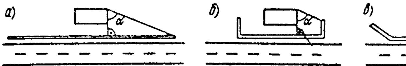
Рис. 16.7. Схемы сокращения длины шумозащитного барьера
