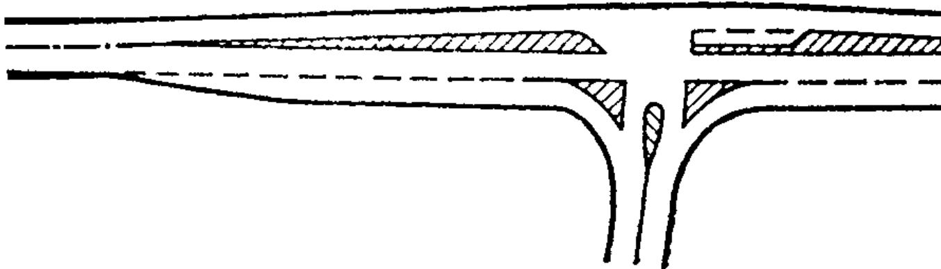
**Рис. 6.10. Направляющие островки на примыкании в одн**
