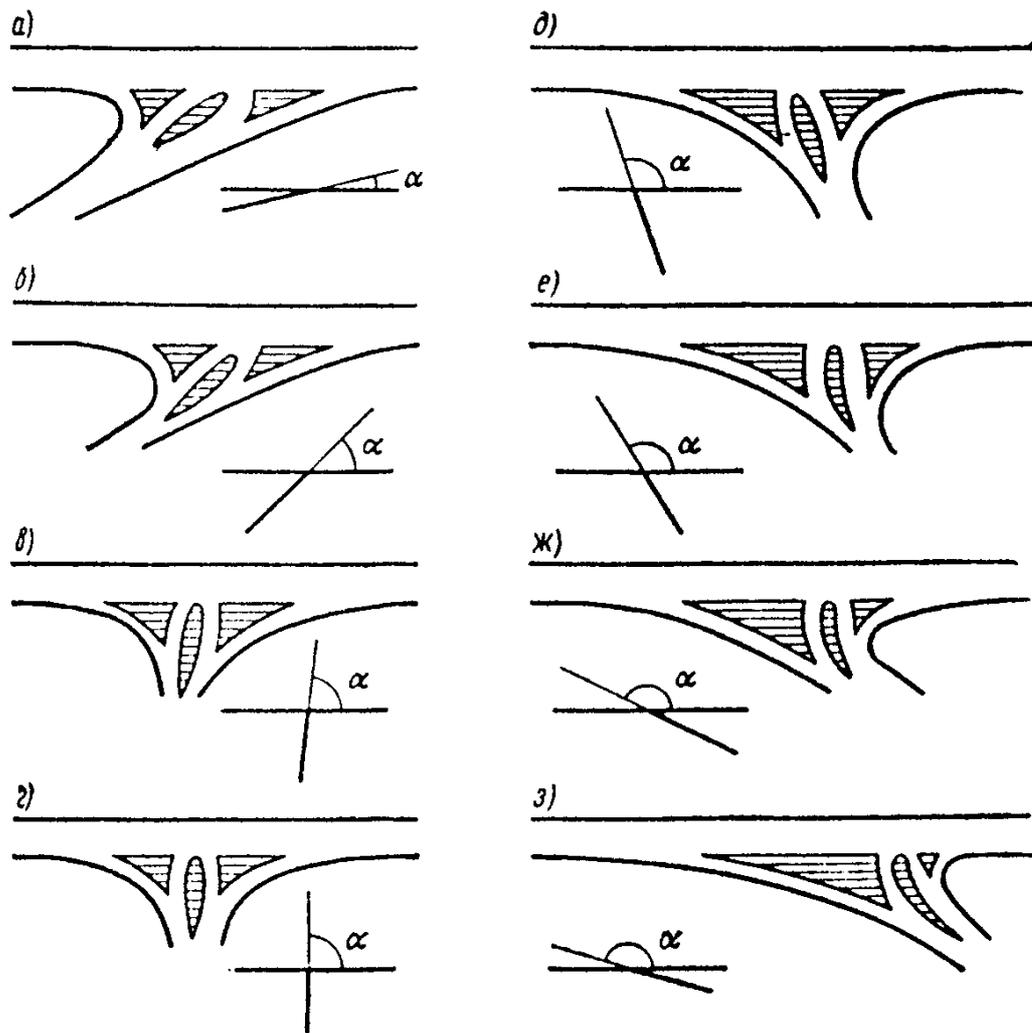
Рис. 6.14. Изменение планировки в зависимости от угла пересечения дорог:
