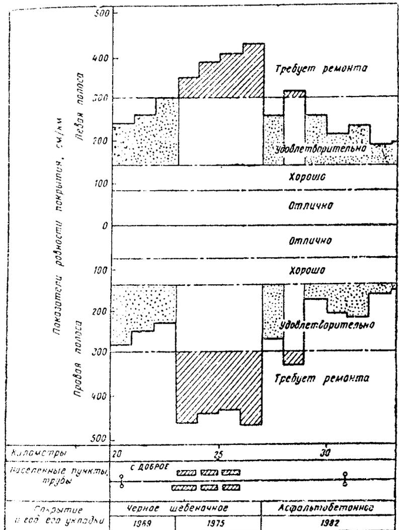
Рис. 2.6. Линейный график ровности
