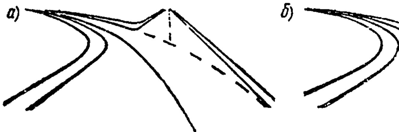
**Рис. 3.5. Пример появления ложного хода (а) и его исправление (б)**
