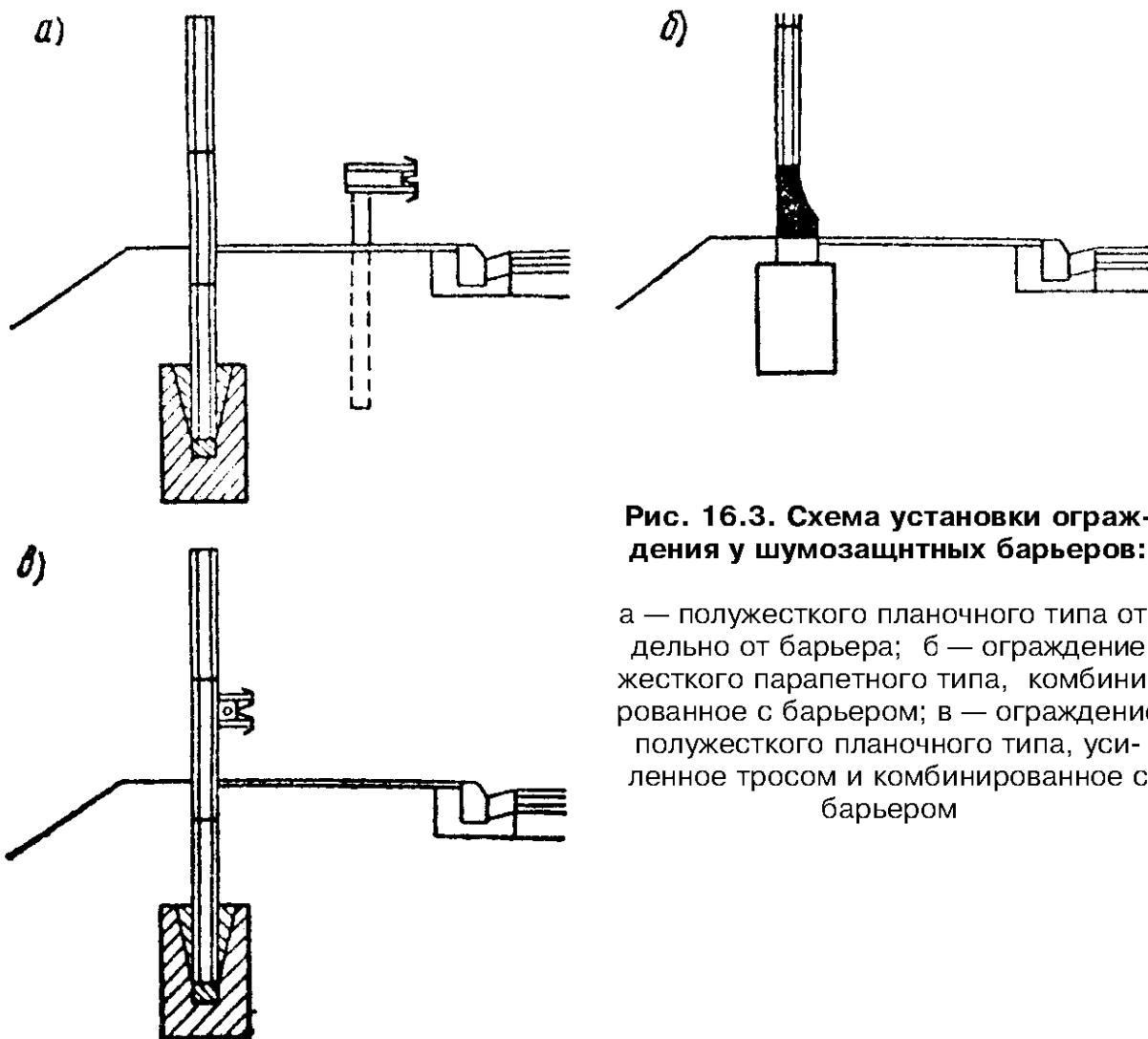
**Рис. 16.3. Схема установки ограждений у шумозащитных барьеров:**
