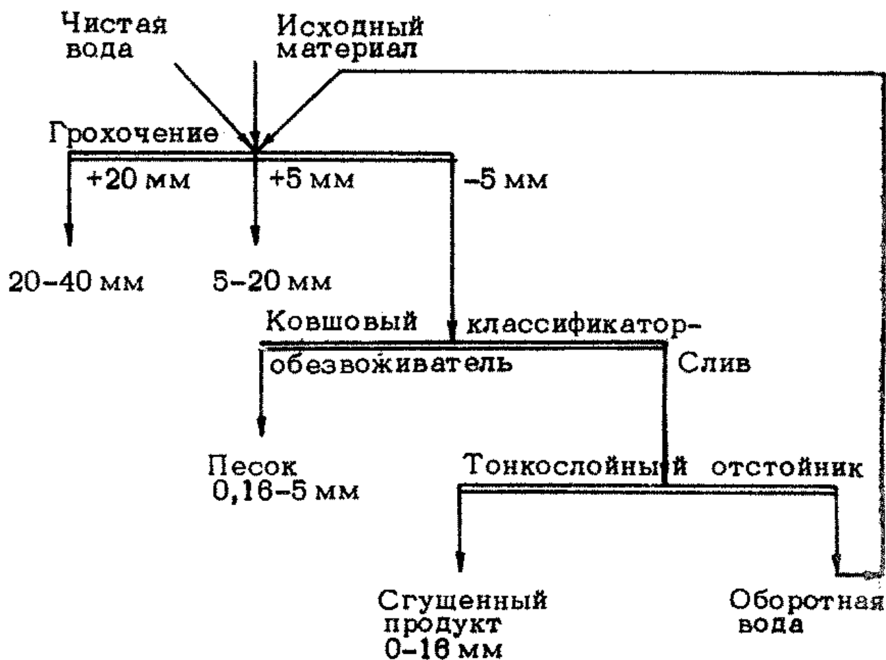
Рис. 6. Технологическая схема "мокрого" обогащения отсеков дробления
