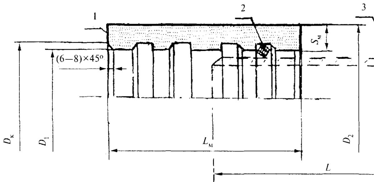
1 — муфта; 2 — кольцо (по 2 шт. на каждую трубу); 3 — труба;  $D_k$  — внутренний диаметр канавки муфты;  $D_2$  — наружный диаметр муфты;  $S_M$  — толщина стенки муфты;  $L_M$  — длина муфты;  $D_1$  — внутренний диаметр трубы;  $S_{o.k}$  — толщина стенки трубы по обточенному концу;  $L$  — длина трубы
