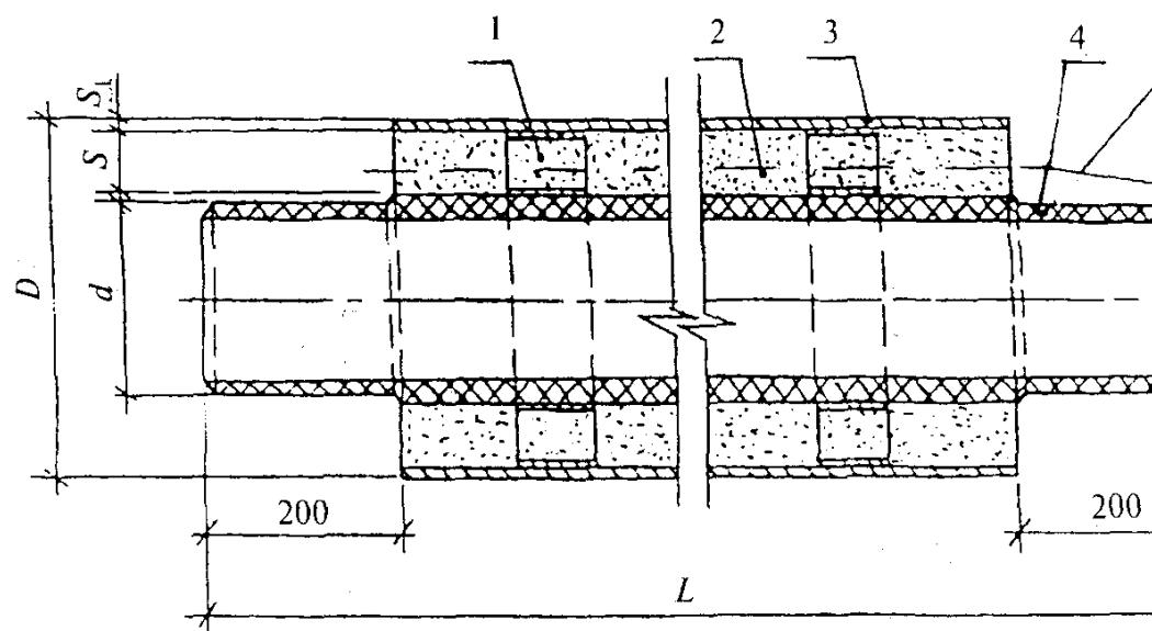
1 — центрирующая опора из полиэтилена ПЭ 63; 2 — изоляция из пенополиуретана; 3 — труба;
