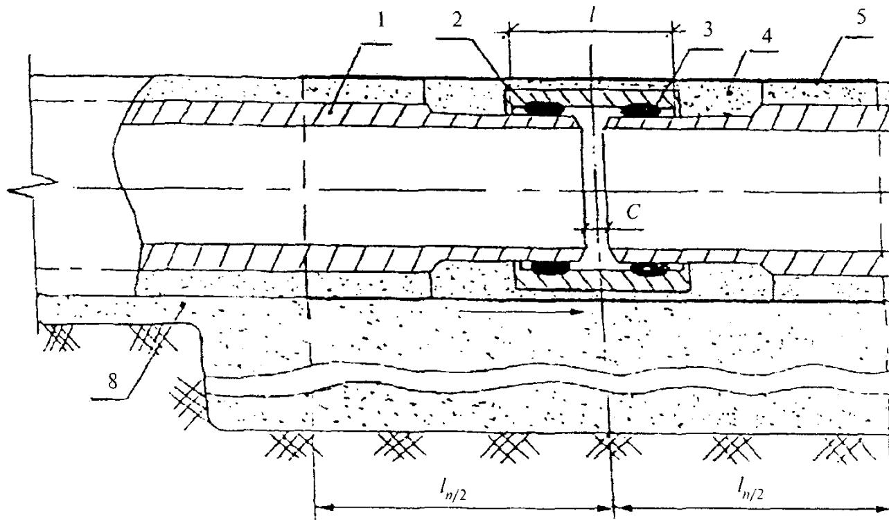
1 — асбестоцементная труба; 2 — асбестоцементная муфта; 3 — резиновые уплотнительные (сегменты) из ППУ или минеральной ваты; 5 — термоусаживающаяся полиэтиленовая лента герметика; 6 — полиэтиленовая оболочка теплоизоляции; 7 — теплоизоляция из ППУ
