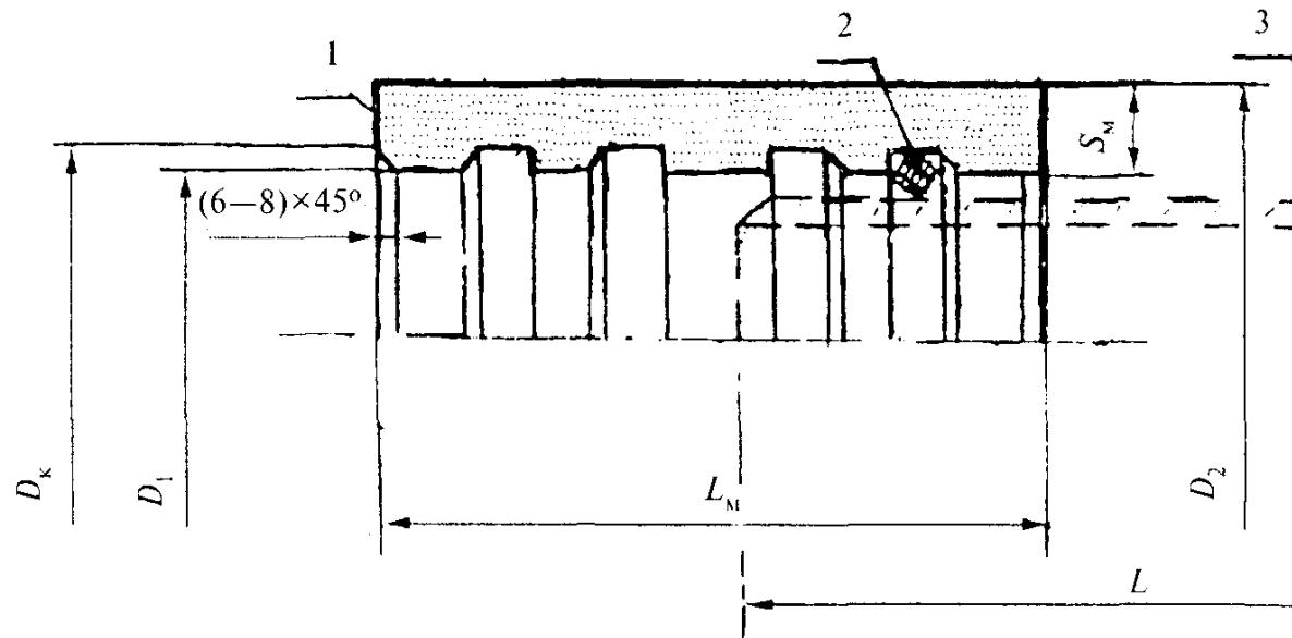
1 — муфта; 2 — кольцо (по 2 шт. на каждую трубу); 3 — труба;  $D_k$  — внутренний диаметр канавки муфты;  $D_2$  — наружный диаметр муфты;  $S_m$  — толщина стенки муфты;  $L_m$  — длина муфты;  $D_{o,k}$  — толщина стенки трубы по обточенному концу;  $L$  — длина трубы
