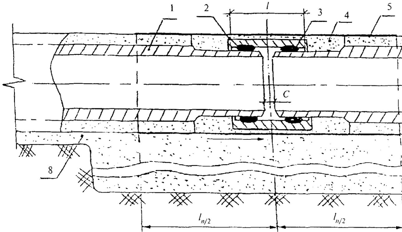
1 — асбестоцементная труба; 2 — асбестоцементная муфта; 3 — резиновые уплотнительные (сегменты) из ППУ или минеральной ваты; 4 — термоусаживающаяся полиэтиленовая лента герметика; 5 — термоусаживающаяся полиэтиленовая лента герметика; 6 — полиэтиленовая оболочка теплоизоляции; 7 — теплоизоляция из ППУ; 8 — фундамент.
