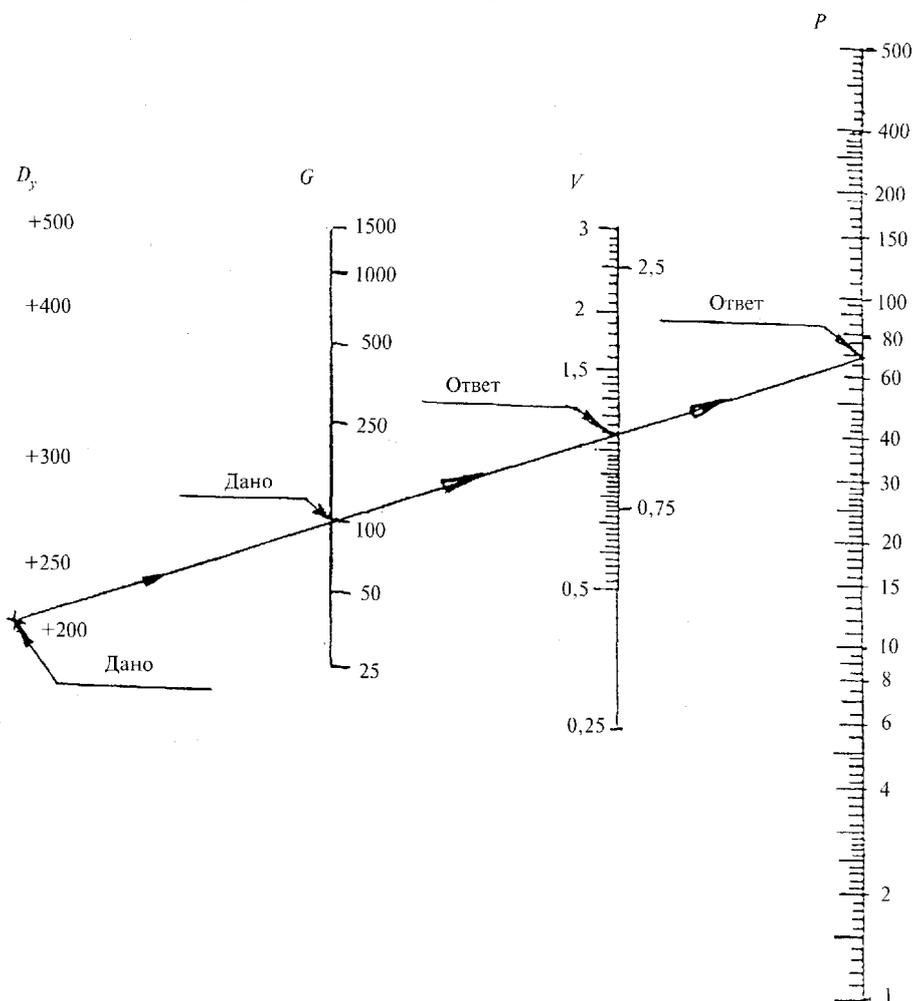
$D_y$  - условный диаметр труб, мм;  $G$  - расход теплоносителя, кг/ч;  $V$  - средняя скорость движения теплоносителя, м/с;
