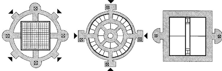
Методом строительства отдельно стоящих входных и лифтовых узлов с круговой обходной галереей при сохранении фронта естественного освещения Реконструируемого здания
