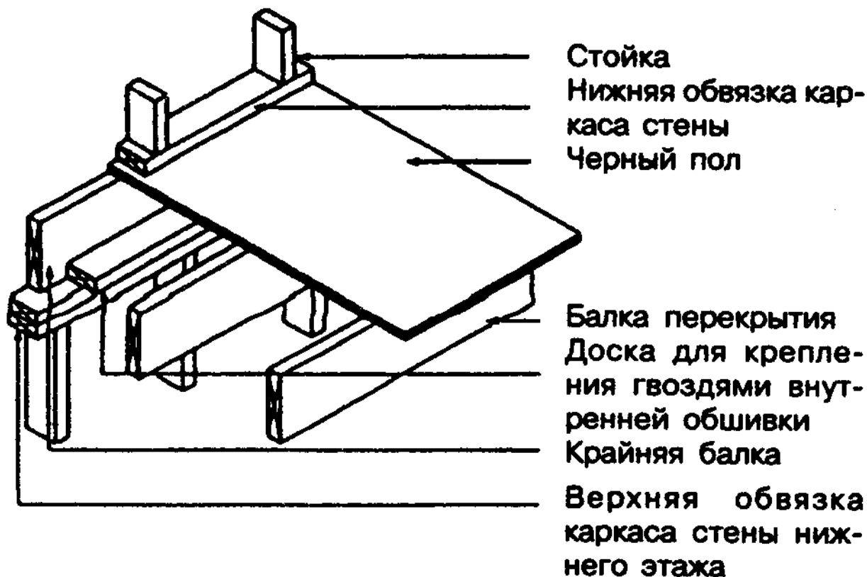
Рисунок 7-4 — Деталь установки доски для крепления внутренней обшивки
