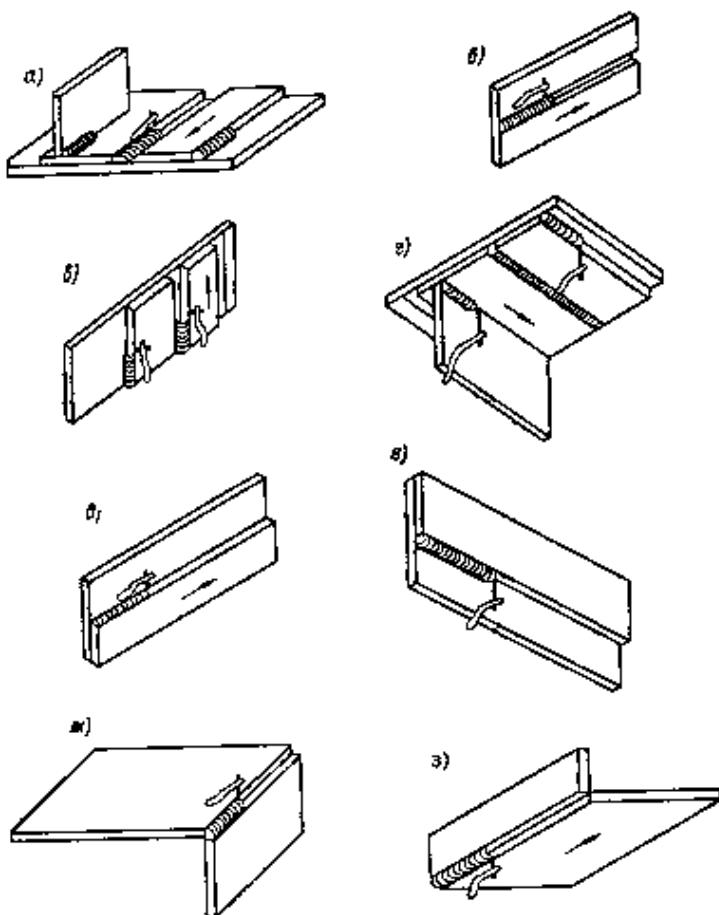
а - шов в нижнем положении стыковых соединений, б - швы в горизонтальном положении стыковых соединений, в - швы в вертикальном положении нахлесточных соединений, г - швы в потолочном положении тавровых и нахлесточных соединений, д - шов нахлесточного соединения, выполняемый в нижнем положении, е - шов соединения, выполняемый в потолочном положении, ж - шов углового соединения, выполняемый в потолочном положении, з - шов углового соединения, выполняемый в нижнем положении.
