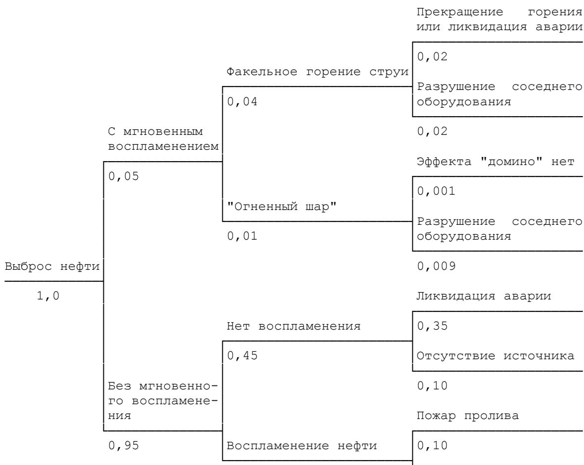
Рис. 1. "Дерево событий" аварий на установке первичной переработки нефти
