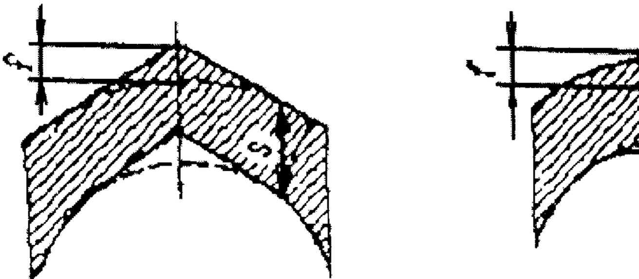
Рис. 1. Увод (угловатость) кромок в сварных швах
