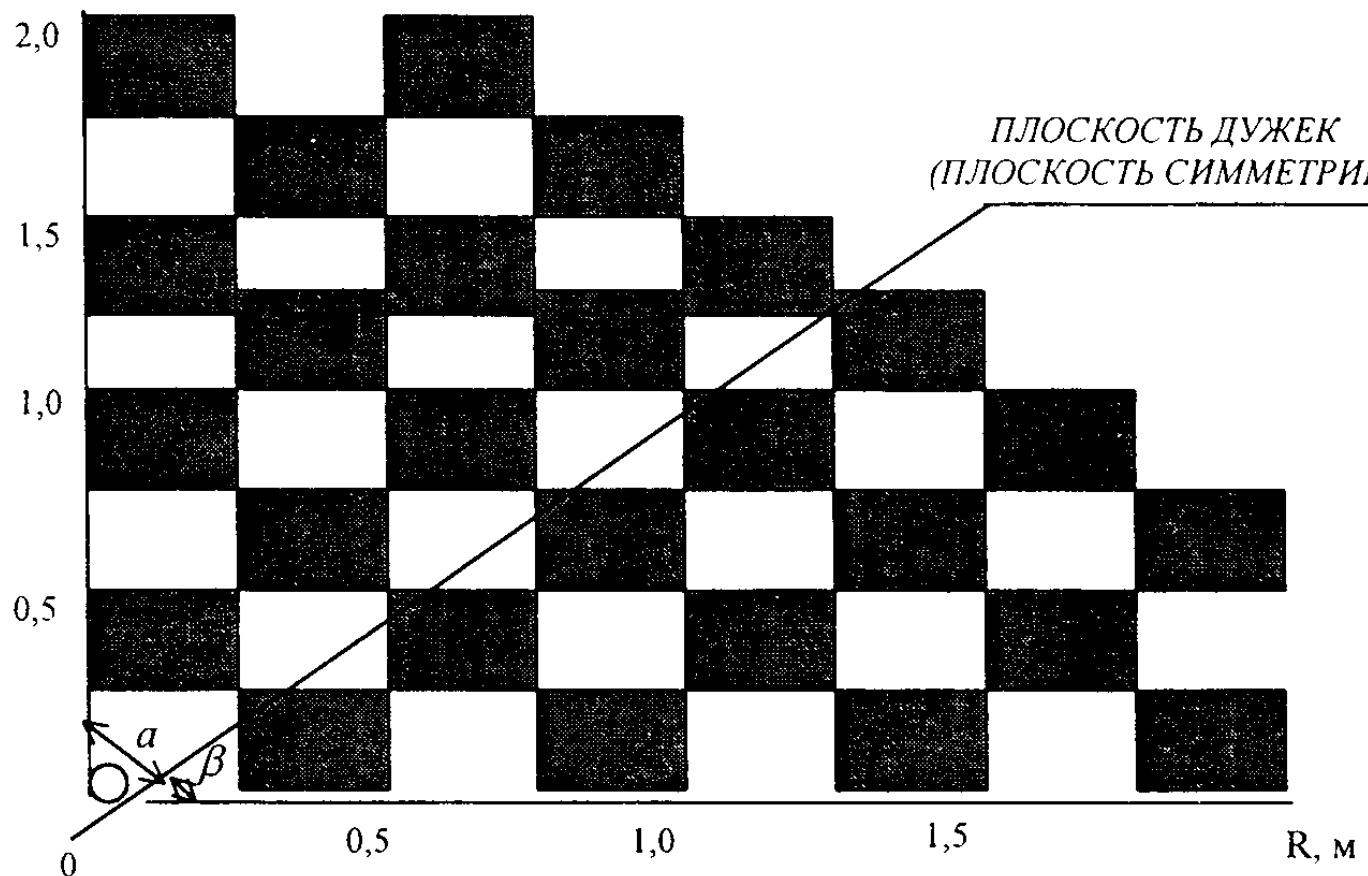
**Рис. 2. Схема расположения мерных банок при испытании водяных оросителей типа В, Н, У:**
