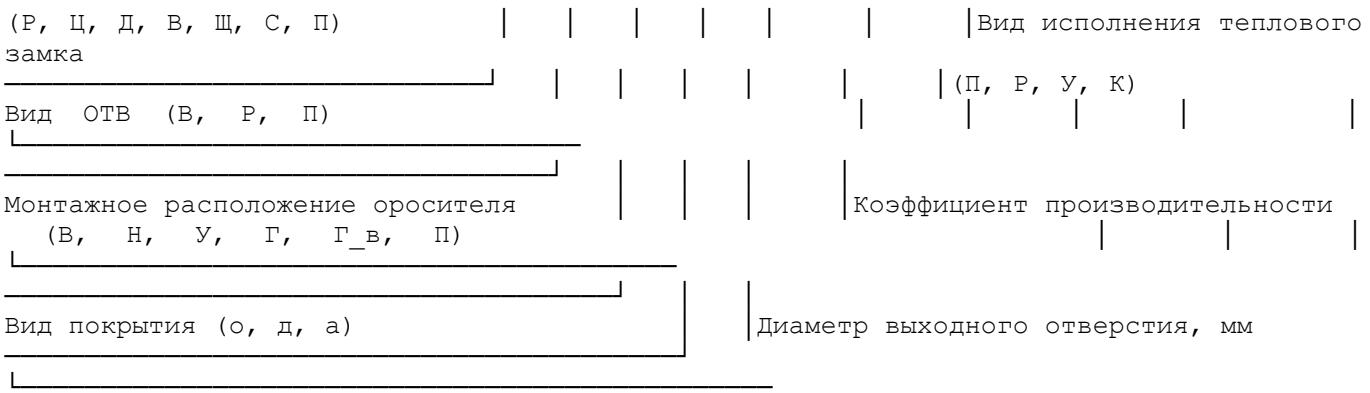
**Примечания:** 1. В обозначении оросителей, формирующих концентрический поток ОТВ, поз.3 допускается не проставлять.
