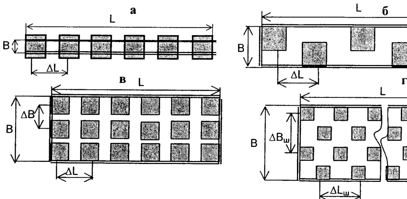
**Рис. 7. Схема расположения мерных банок при испытании оросителей, формирующее вертикальное направление потока ОТВ:**
