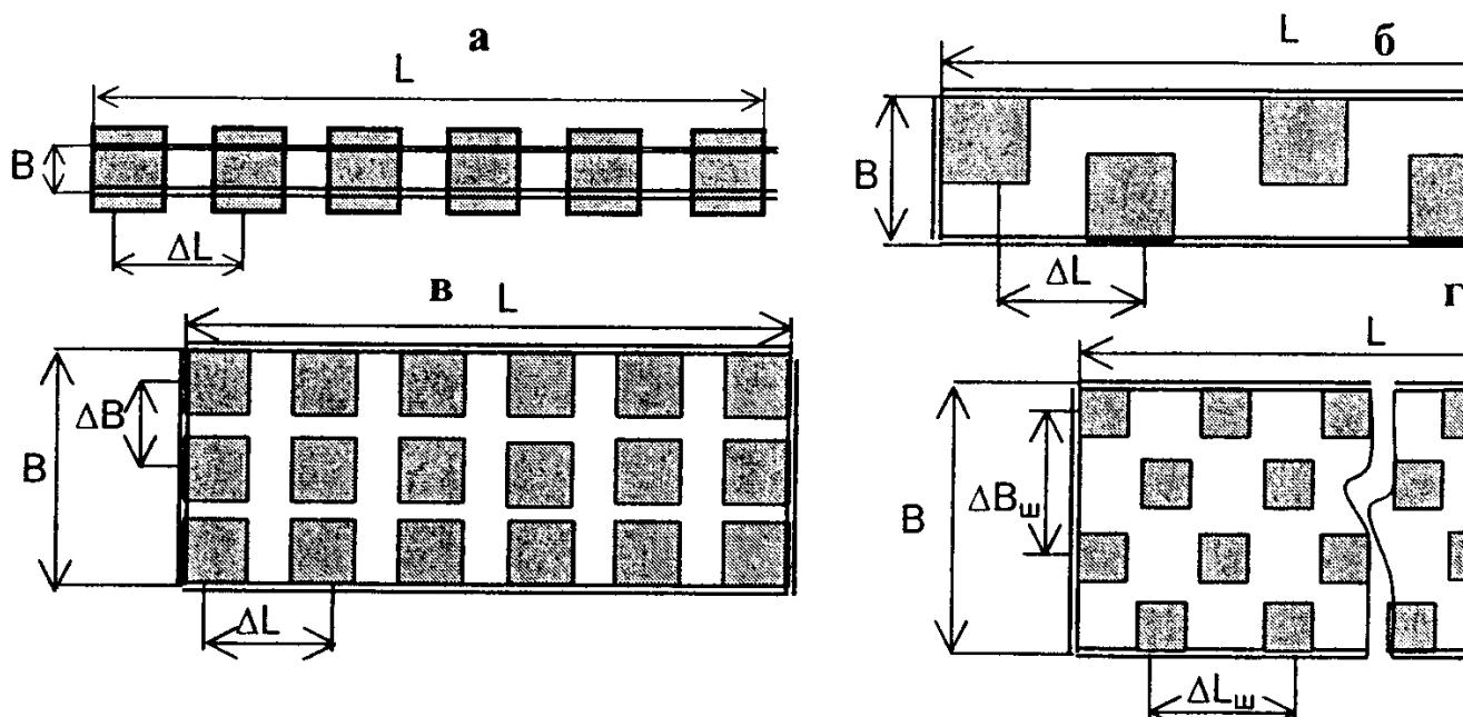
**Рис. 7. Схема расположения мерных банок при испытании оросителей, формирующих вертикальное направление потока ОТВ:**
