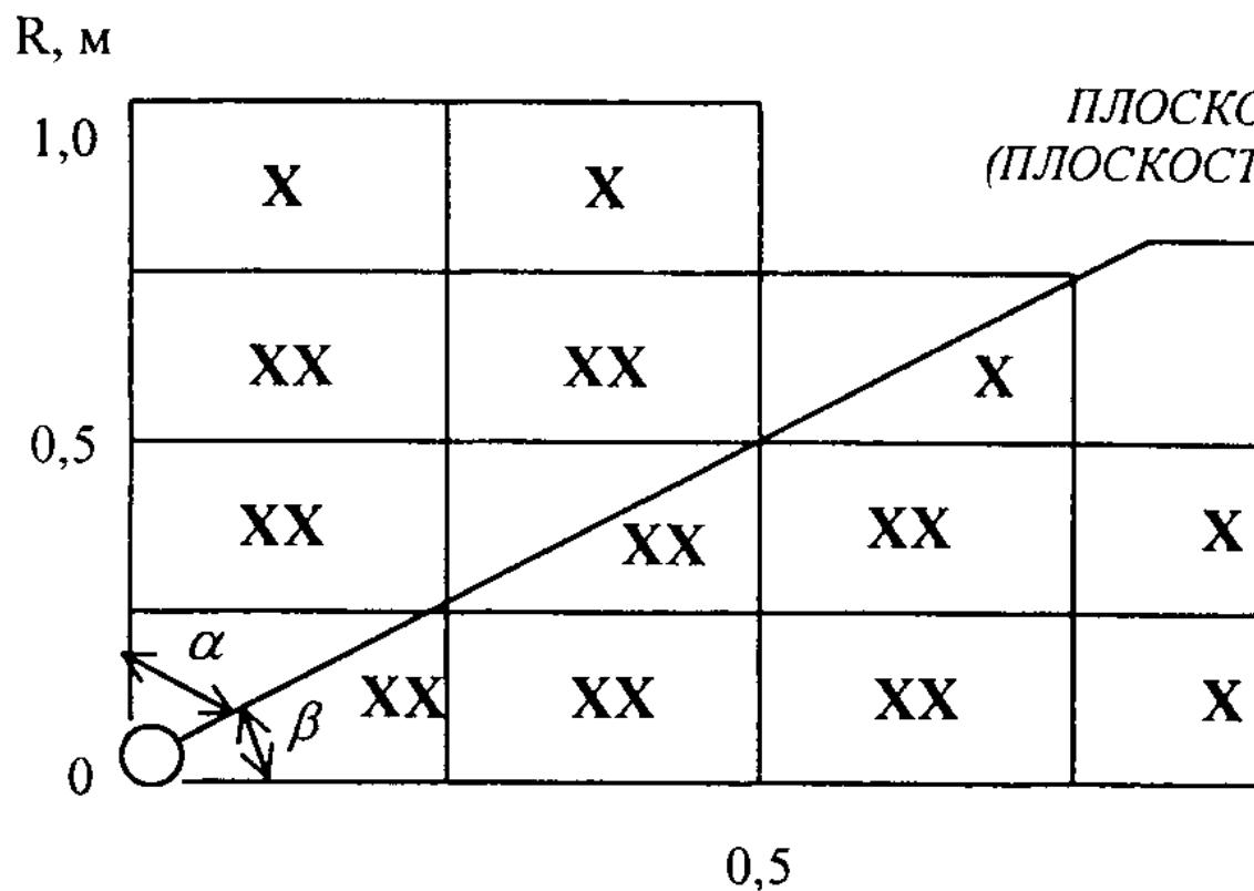
**Рис. 4. Схема расположения мерных банок при испытании оросителей для стеллажных складов с  $d_y=10$  и 12 мм**
