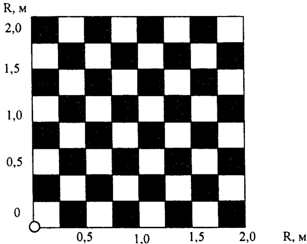
**Рис. 6. Схема расположения мерных банок при испытании оросителей, формирующих концентричное орошение**
