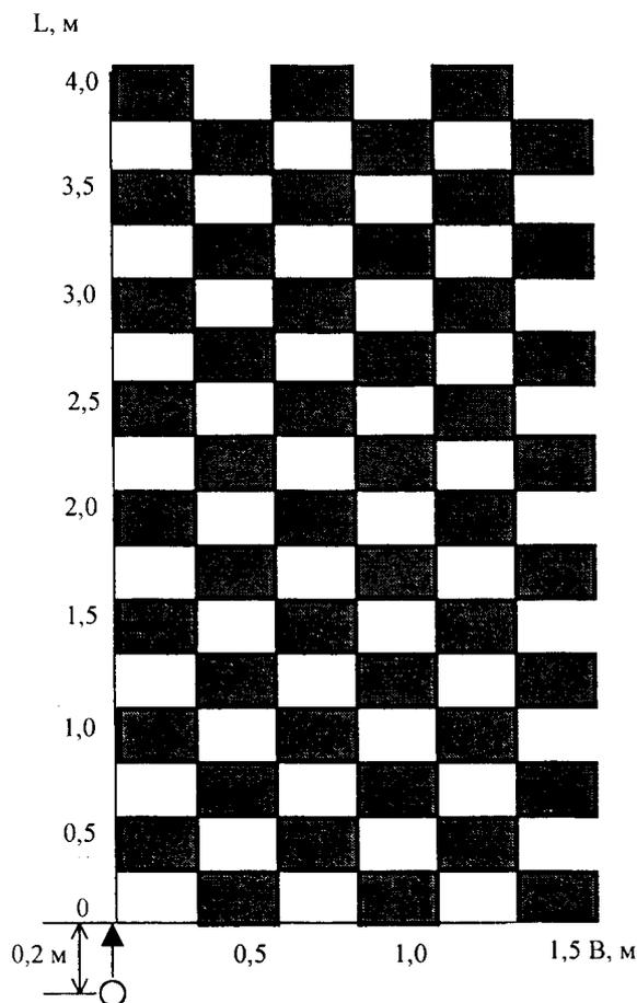
**Рис. 3. Схема расположения мерных банок при испытании водяных оросителей типа Г и Г<sub>в</sub>:**
