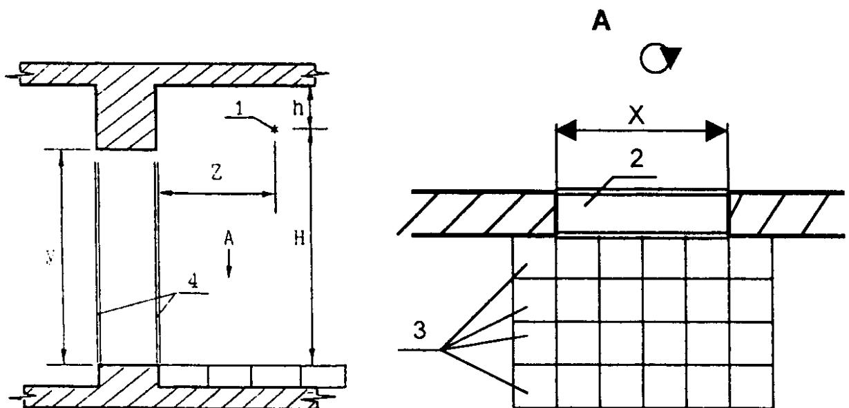
**Рис. 8. Схема размещения оросителей и мерных банок при испытании оросителей, формирующих горизонтальное направление потока ОТВ:**
