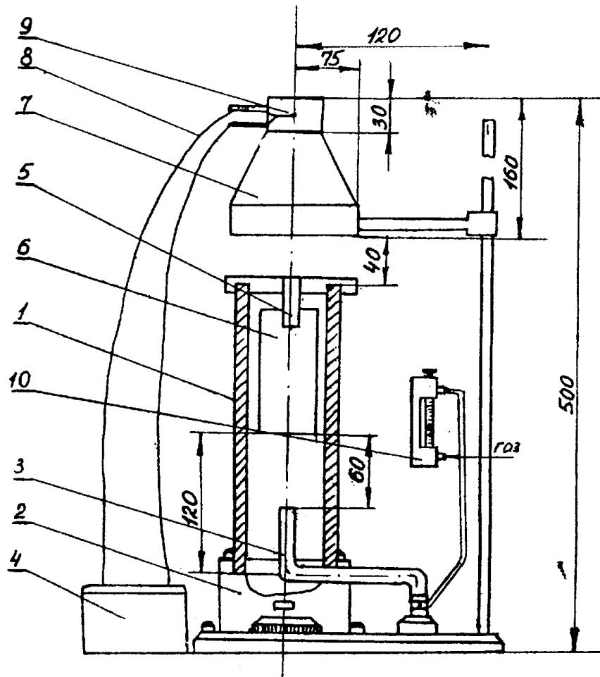
Рис. 1. Установка для определения огнезащитной эффективности ОЗСВ:
