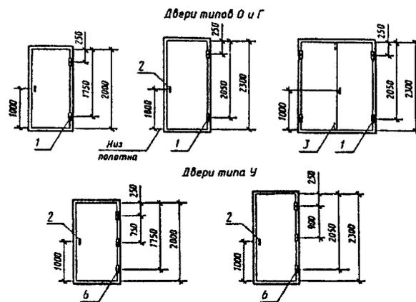
1 — петли ПН1—110, ПН1—85, ПН2—110, ПН2—85, ПН3—110, ПН4; 2 — ручки РС100, РС140, РК1, РК2, замки и защелки;
