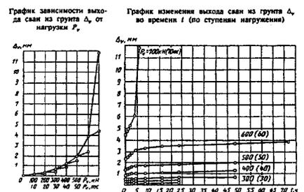
"Образец графического оформления результатов полевого испытания вечномерзлых грунтов статическими вдавливающими и выдергивающими нагрузками при инженерных изысканиях для строительства"
