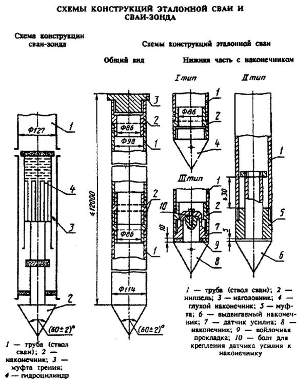
"Схемы конструкций эталонной сваи и сваи-зонда"
