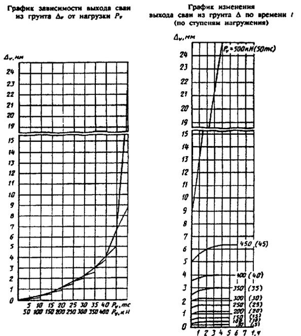
"Образец графического оформления результатов полевого испытания талых грунтов статической выдергивающей нагрузкой"
