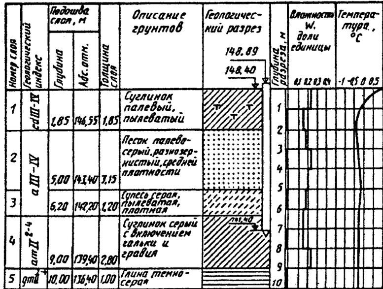
"Образец графического оформления инженерно-геокриологического разреза для полевых испытаний вечномерзлых грунтов сваями"
