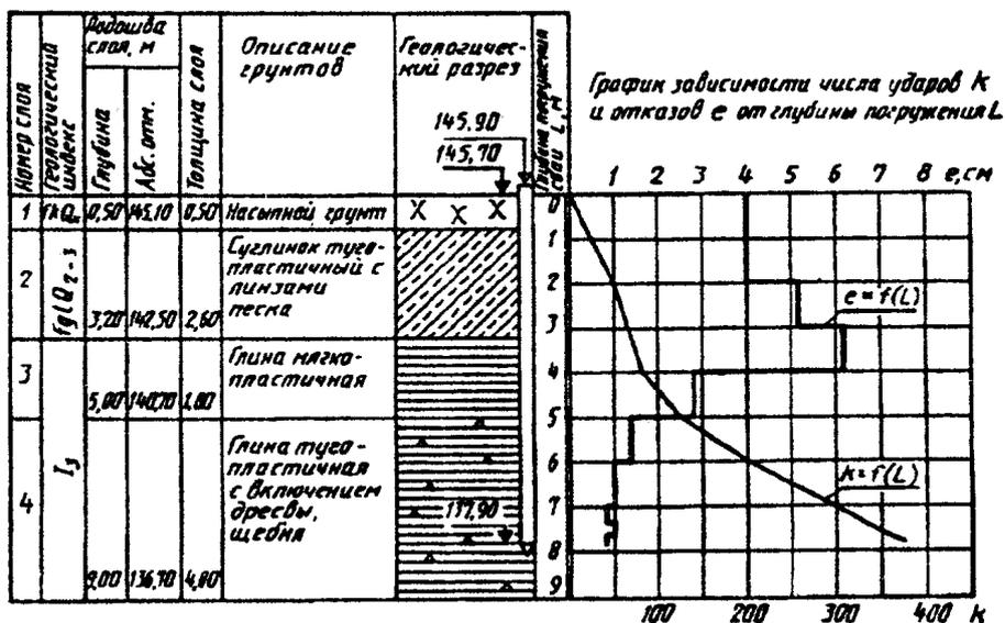
"Образец графического оформления результатов полевого испытания талых грунтов динамической нагрузкой"
