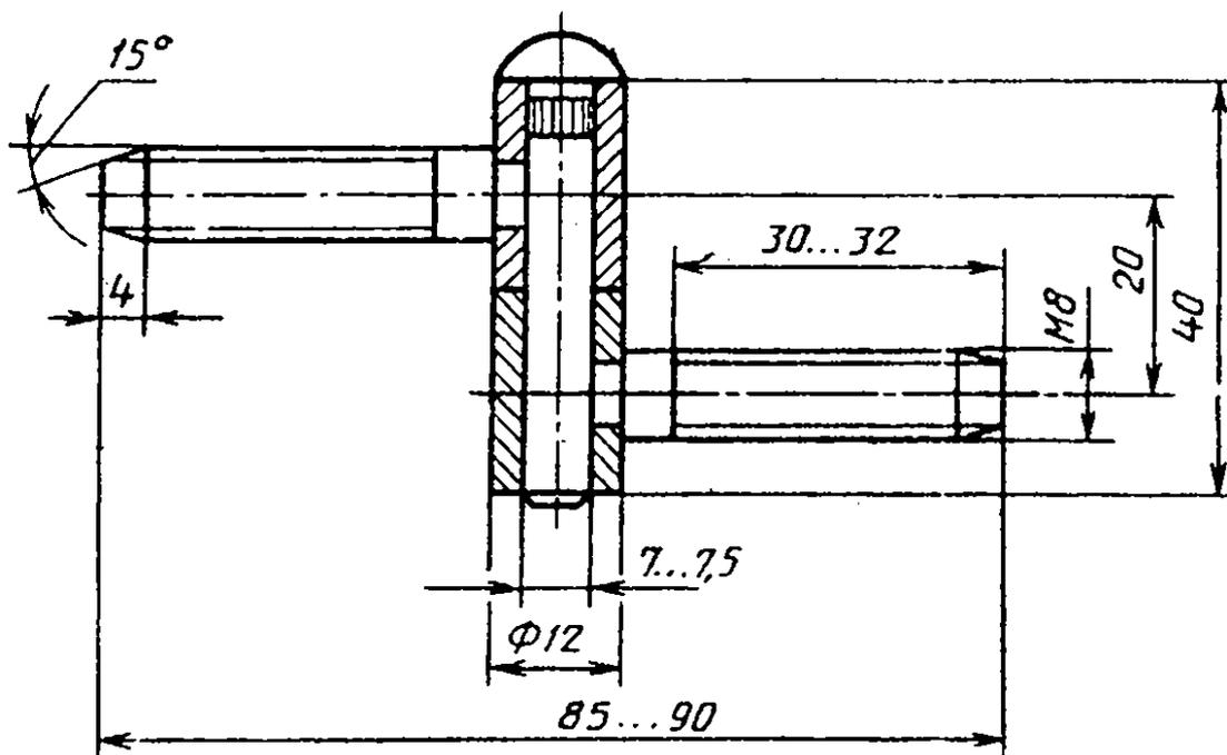
Рисунок Б16 — Петля ввертная типа ПВв2
