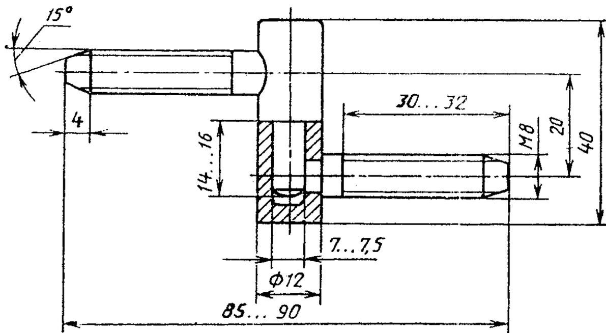
Рисунок Б17 — Петля ввертная типа ПВв3
