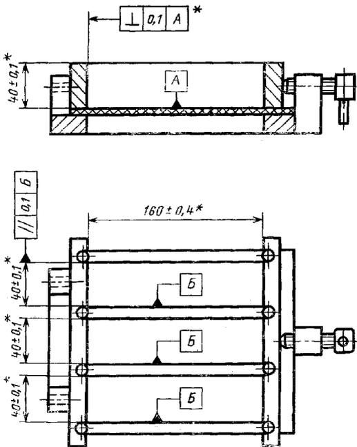
\* Допуск для изготовления формы.
