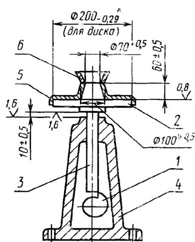
\* Для испытания цемента с расплывом конуса более 200 мм применяют диск диаметром 300 мм. Указанный допуск — для изготовления.
