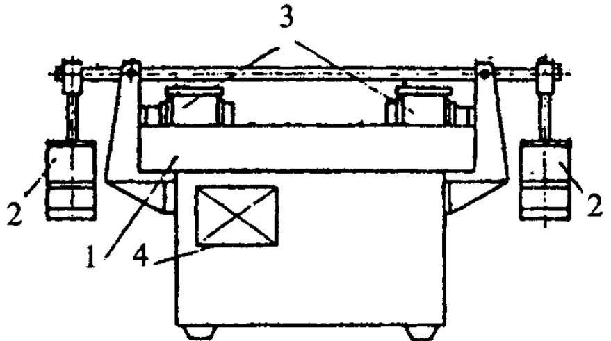
**1 — истирающий диск; 2 — нагружающее устройство; 3 — испытываемый образец; 4 — счетчик оборотов**
