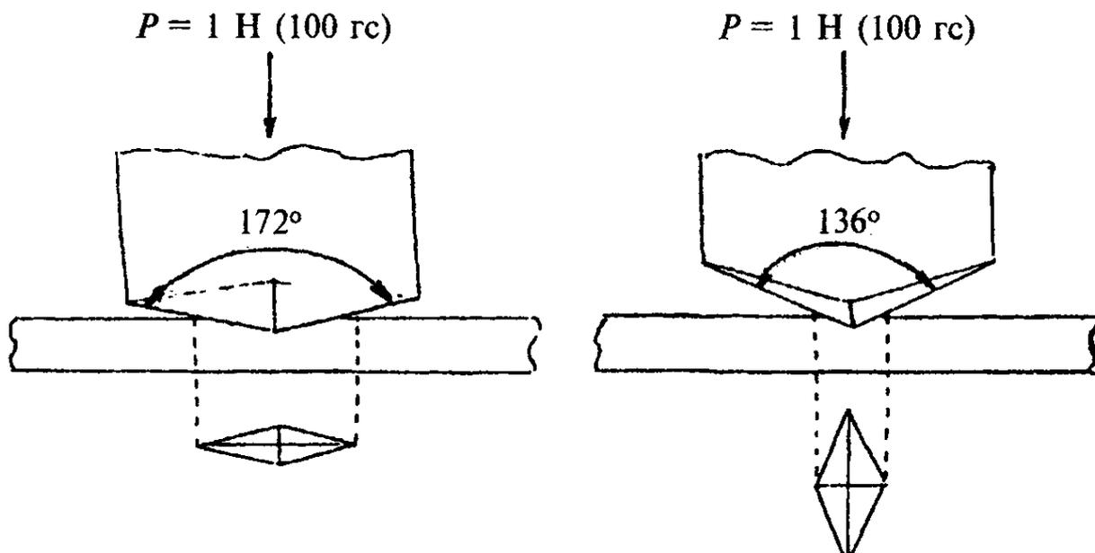
**Рисунок 7 — Алмазный наконечник (пирамида) твердомера**
