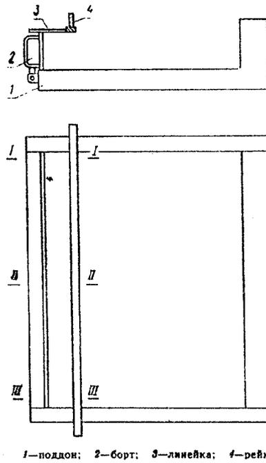
"Чертеж. Измерение прогиба борта с помощью рейки"
