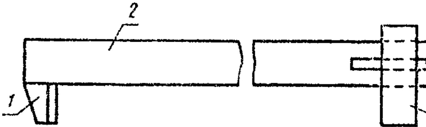
**1—неподвижный упор; 2—балка (брус, труба); 3—линейка с миллиметровыми делениями; 4—подвижной упор**
