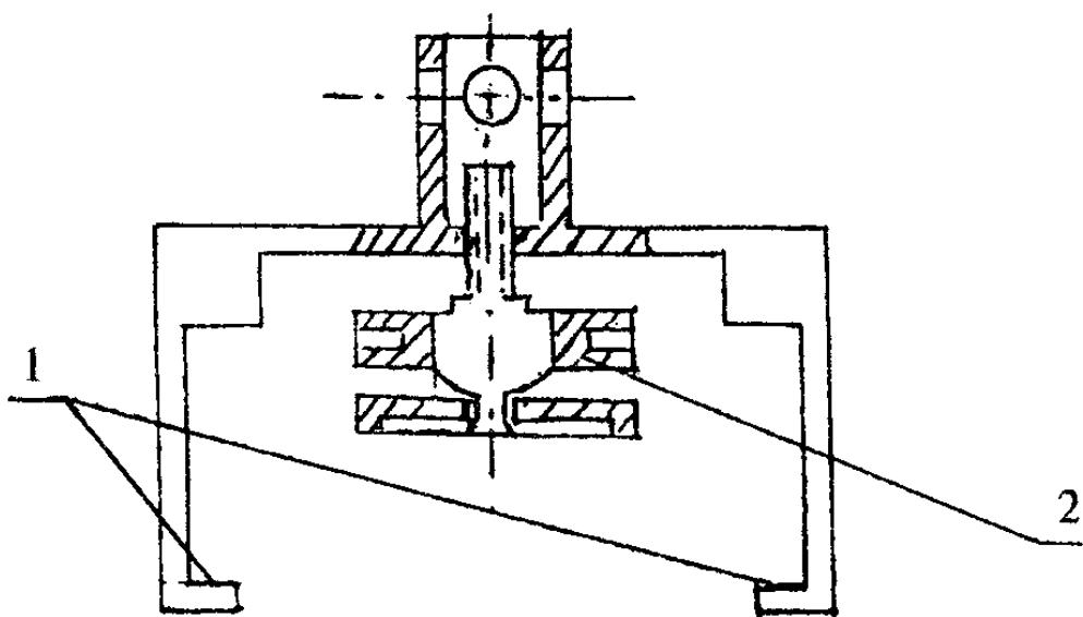
1 — рабочая поверхность захвата; 2 — прижимной винт
