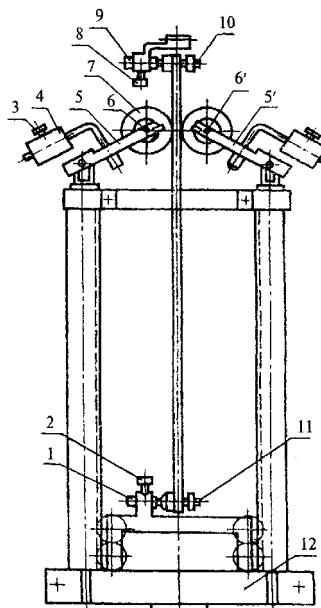
1 — нижний зажим; 2,8 — затягивающие винты; 3 — закрепляющий винт; 4 — противовес; 5, 5' — нагружающие рычаги; 6, 6' — оси; 7 — ролик; 9 — верхний зажим; 10,11 — фиксирующие винты; 12 — основание приспособления
