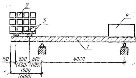
1 — испытываемая плита; 2 — нагрузка на всю ширину плиты; 3 — деревянные брусья сечением 10×10 см; 4 — пригрузочный баласт
