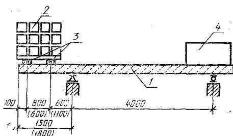
1 — испытуемая плита; 2 — нагрузка на всю ширину плиты; 3 — деревянные бруски сечением 10×10 см; 4 — пригрузочный балласт
