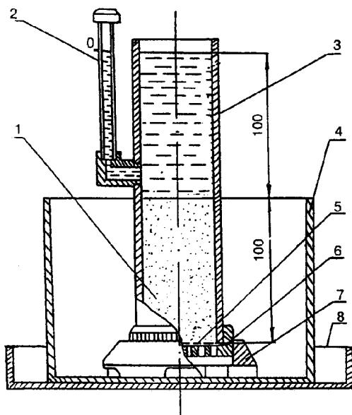
1 — образец грунта; 2 — пьезометр; 3 — трубка;
