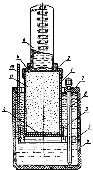
1 — цилиндр; 2 — муфта; 3 — перфорированное дно; 4 — латунная сетка; 5 — подставка; 6 — корпус; 7 — крышка; 8 — подъемный винт; 9 — стеклянный баллон со шкалой объема фильтрующейся жидкости; 10 — планка со шкалой градиентов напора; 11 — образец грунта
