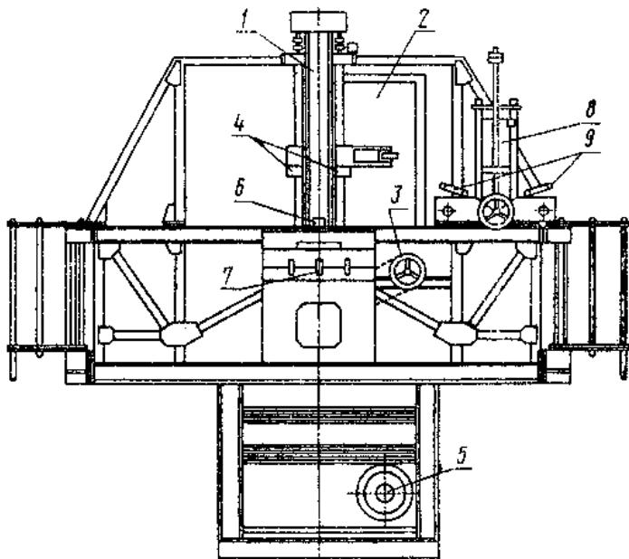
1—стойка; 2—испытуемое изделие; 3—привод; 4—рычаги-толкатели;
