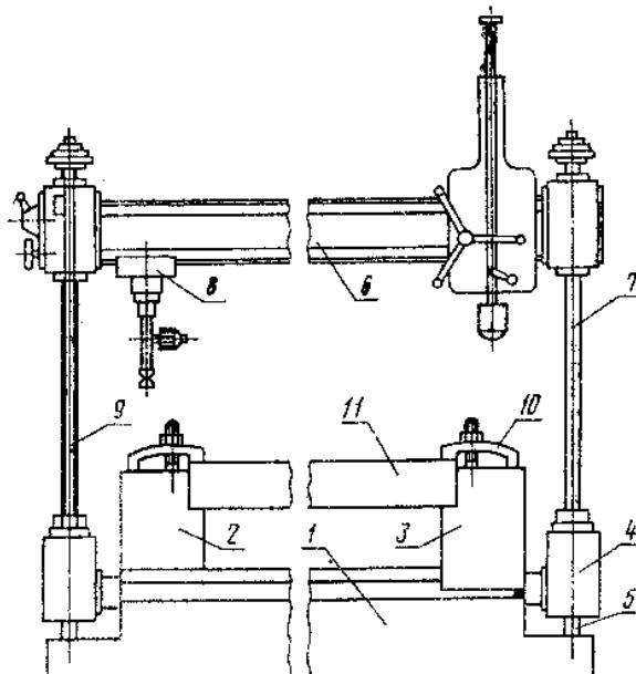
1—основание машины; 2—неподвижная опора; 3—подвижная опора; 4—каретка; 5—направляющая каретки; 6—траверса; 7—колонка для перемещения траверсы; 8—датчик сил; 9—измеритель перемещений; 10—прижимы; 11—испытуемое изделие.
