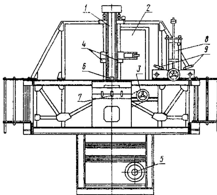
1—стойка; 2—испытуемое изделие; 3—привод; 4—рычаги-толкатели;
