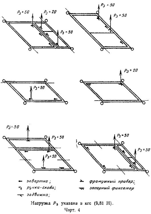
"Чертеж 4. Испытание образца на сопротивление статической сосредоточенной нагрузке, действующей на запорные приборы и ручки, находящиеся в рабочем положений, в сторону открывания створки"
