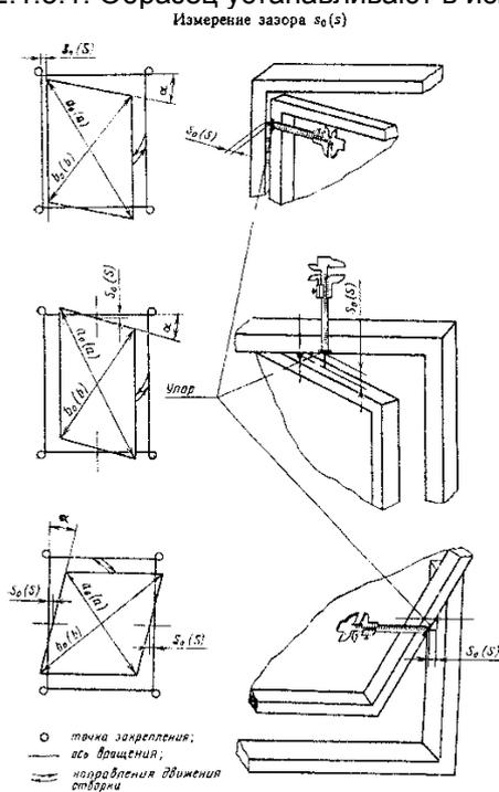
"Чертеж 1. Измерение зазора"
