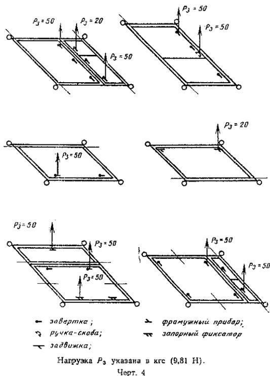
"Чертеж 4. Испытание образца на сопротивление статической сосредоточенной нагрузке, действующей на запорные приборы и ручки, находящиеся в рабочем положении, в сторону открывания створки"
