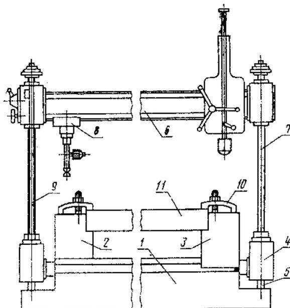
1—основание машины; 2—неподвижная опора; 3—подвижная опора; 4—каретка; 5—направляющая каретки; 6—траверса; 7—колонка для перемещения траверсы; 8—датчик сил; 9—измеритель перемещений; 10—прижимы; 11—испытываемое изделие.
