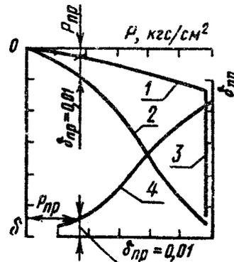
1, 2—относительное сжатие  $\delta$  грунта с природной влажностью и в водонасыщенном состоянии в зависимости от давления; 3—дополнительное относительное сжатие грунта в результате замачивания (относительная просадочность) при заданном давлении; 4—зависимость относительной просадочности  $\delta_{пр}$  от давления;  $P_{пр}$ —начальное просадочное давление
