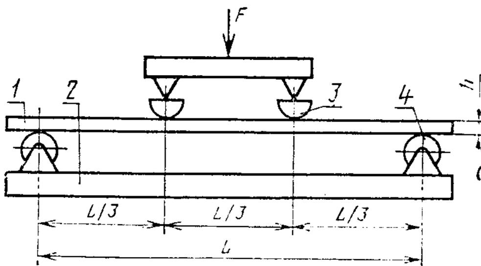
1—образец; 2—основание; 3—нагружающий элемент;
