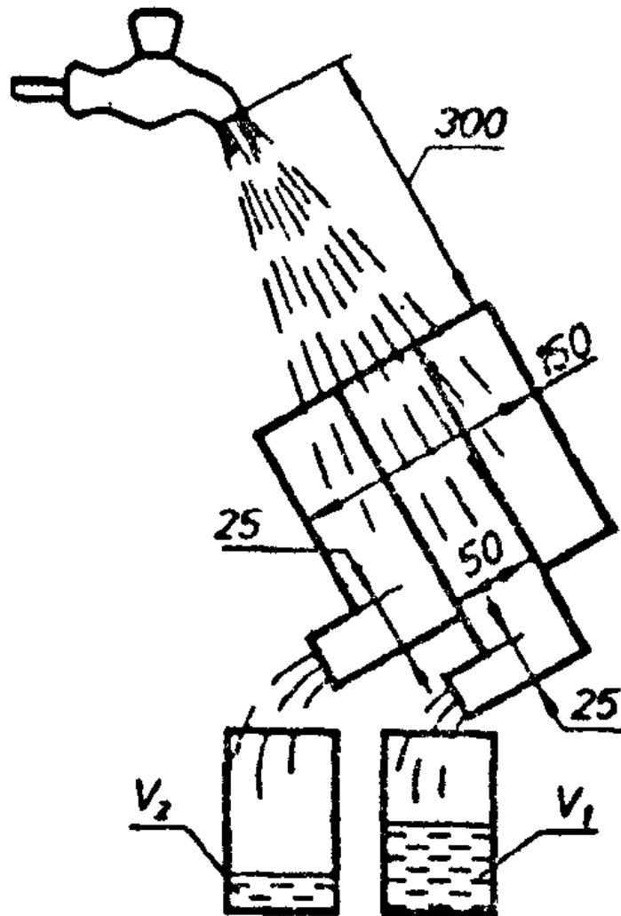
**Рисунок 1 – Схема определения компактности струи**
