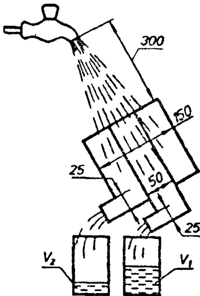
**Рисунок 1 – Схема определения компактности струи**
