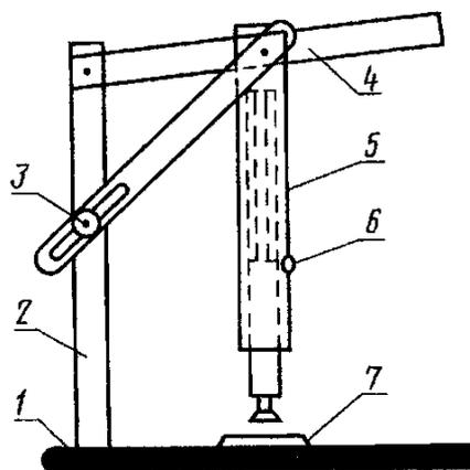
1 — основание; 2 — стойка; 3 — установочный винт; 4 — рычаг; 5 — гильза с винтовой пружиной; 6 — винт; 7 — пластинка для испытания
