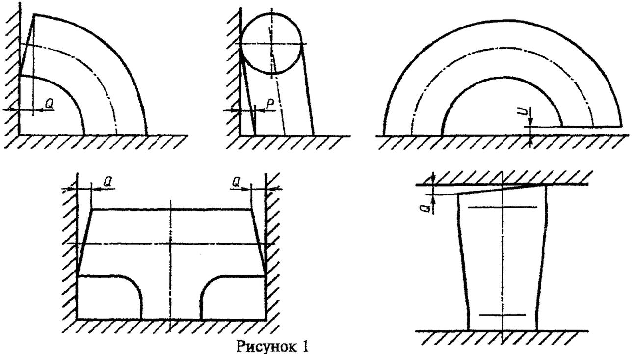
"Рисунок 1. Предельные отклонения размеров и расположения поверхностей деталей"
