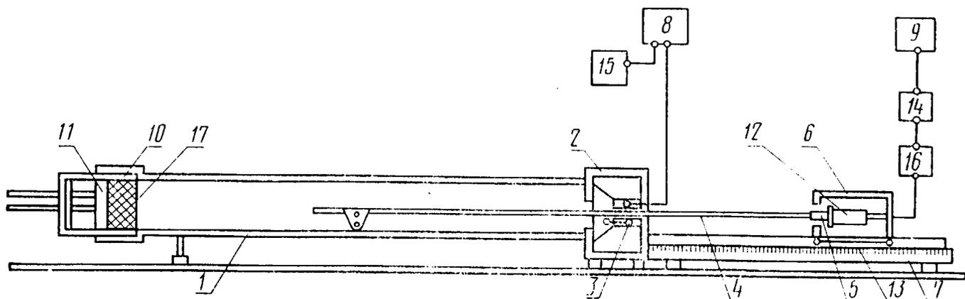
1 — металлическая труба; 2 — коробка; 3 — громкоговоритель; 4 — микрофонный щуп; 5 — резиновая диафрагма; 6 — микрофонная тележка; 7 — направляющая рейка; 8 — низкочастотный генератор; 9 — электронный вольтметр; 10 — обойма; 11 — поршень; 12 — микрофон; 13 — указатель отсчета; 14 — акустический фильтр; 15 — электронно-счетный частотомер; 16 — микрофонный усилитель; 17 — лицевая поверхность образца
