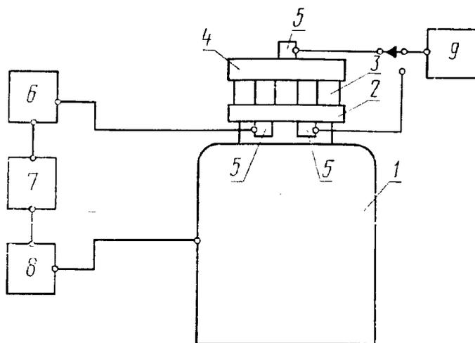
1 — электродинамический вибратор; 2 — столик вибратора; 3 — испытываемый образец; 4 — груз; 5 — акселерометры; 6 — измерительный усилитель; 7 — измерительный генератор; 8 — усилитель мощности; 9 — виброизмеритель
