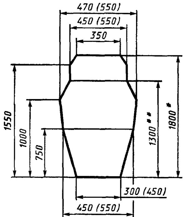
\* Высота дверного проема при максимально возможной открытой двери кабине работы стоя.
