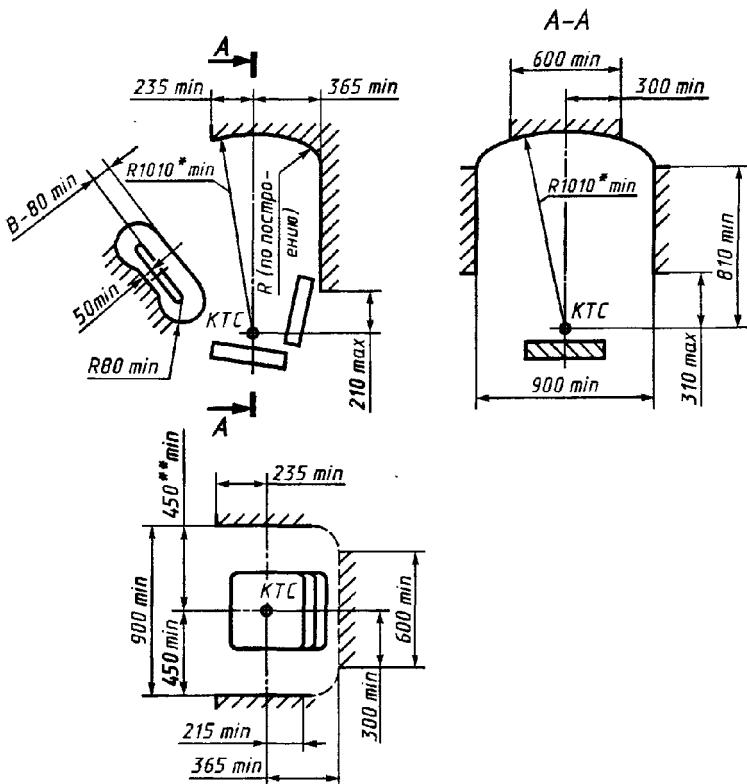
\* Допускается в обоснованных случаях по согласованию с потребителем уменьшение радиуса  $R$  1010 не более чем на 100 мм, а для кабин тракторов с мягкой обивкой потолков — на 150 мм.
