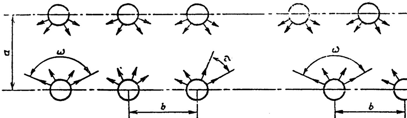
$\omega$  — угол охвата, град.;  $\tau$  — угол между оптическими осями, град.;  $a$  — ширина освещаемой площади, м.
